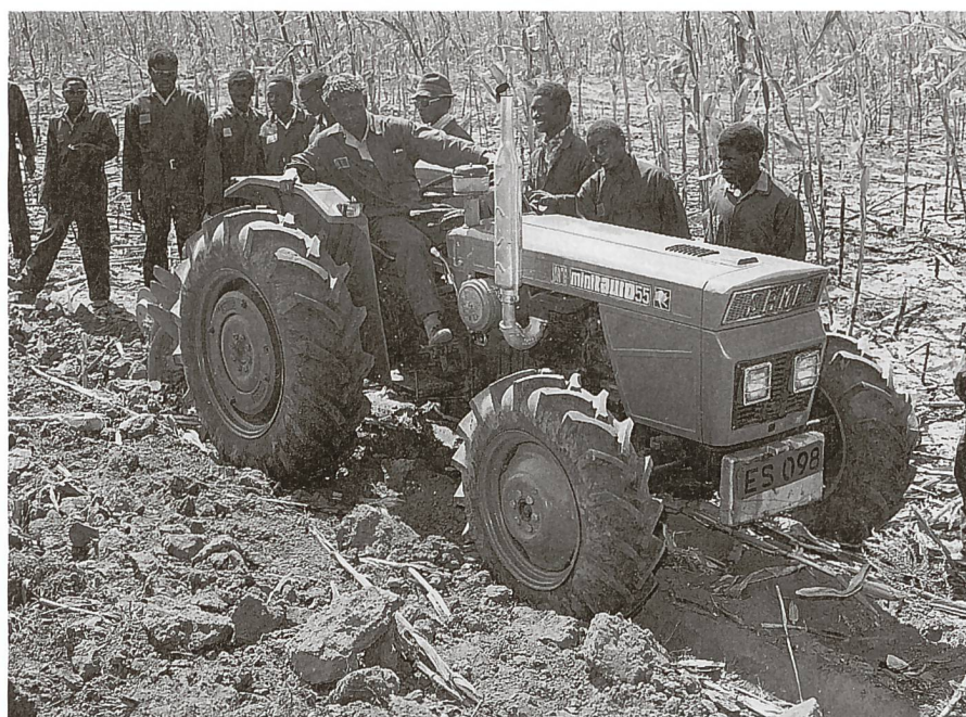
Same Minitauro in den 1960er-Jahren in Afrika: Luftkühlung ist in trockenen Gebieten beliebt.
