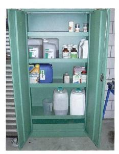
Ein Pflanzenschutzmittelschrank muss aus Metallblechen gefertigt sein. (Bilder: BUL)
