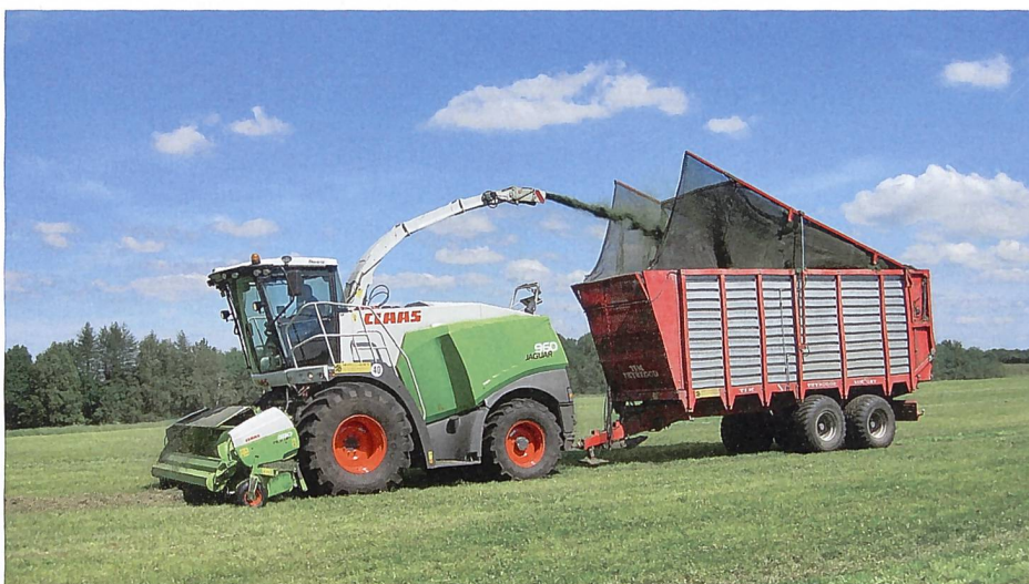
DK: Im dänischen CTF-System mit zwölf Meter wird nicht mehr auf ein parallel fahrendes Transportfahrzeug übergeladen. Hier zieht der Häcksler direkt den Anhänger. Der Spurflächenanteil beträgt mit 800 mm breiten Reifen etwa 13 Prozent. Quelle: Danny Pedersen.
