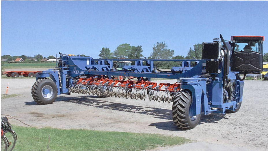
NL: Geräteträger mit drei Standardanbaugeräten à drei Meter Breite in den drei Dreipunktanhängungen. (Quelle: Hans Henrik Pedersen)
