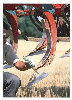
Mit einem Hammerschlag, ohne Entfernen von Spannhülsen oder Splinten, lassen sich die Knock-on- Schare demontieren.
