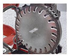
Horsch verwendet keine Säscheiben mit Löchern, sondern solche mit geschwungenen Schlitzen. Eine Grundvoraussetzung für hohe Geschwindigkeiten.
