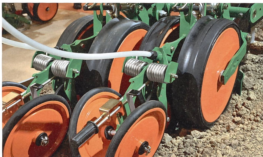
Durch dieses Schussrohr kommen die Körner geschossen. Beim Verlassen des Rohres werden sie von einer weichen Fangrolle aufgefangen.
