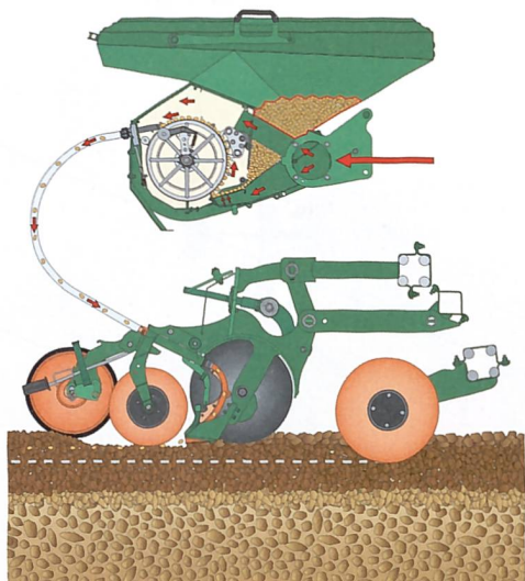
Systematischer Aufbau der EDX von Amazone.
