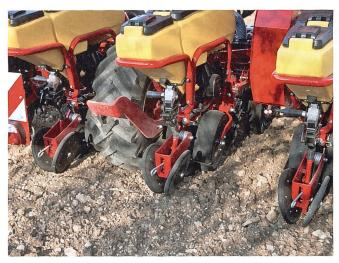
Unmittelbar vor/zwischen den Andruckrollen ist die Fangrolle angeordnet. Sie übernimmt das Korn und sichert optimalen Bodenkontakt.
