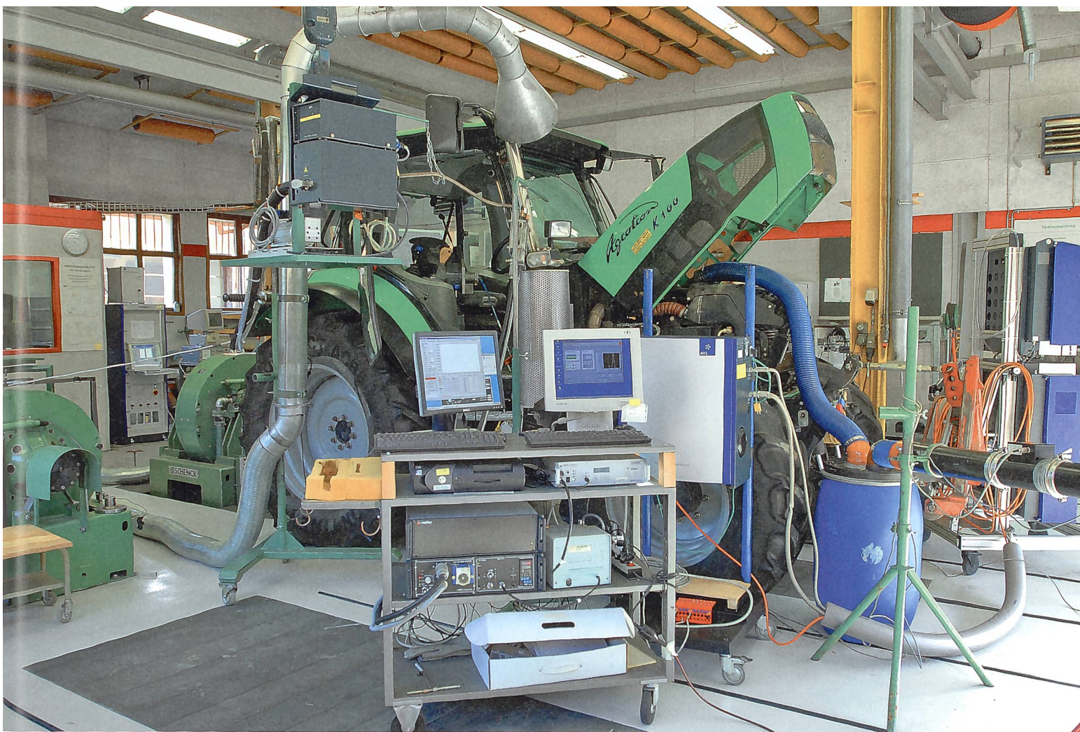
Messung der Zapfwellenleistung nach OECD-Norm im Traktorenlabor von Agroscope.
