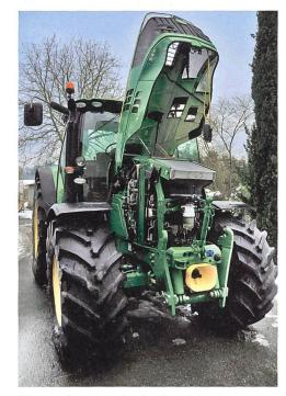
Die einteilige Motorhaube lässt sich sehr weit aufklappen und ermöglicht einen guten Zugang zu den Wartungspunkten.
