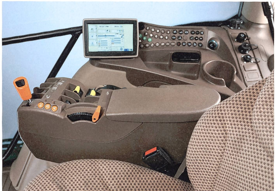
Der Schalthebel für das DirectDrive sitzt in der CommandArm-Armlehne. Die Bedienung ist sehr einfach: In der rechten Position ist der Automatikmodus, in der Kulisse links kann das Getriebe manuell geschaltet werden.
