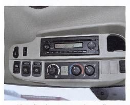
Die Bedienelemente von Heizung/Klimaanlage und Radio sind gut platziert.
