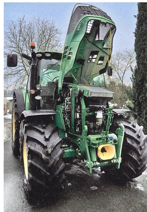
Die einteilige Motorhaube lässt sich sehr weit aufklappen und ermöglicht einen guten Zugang zu den Wartungspunkten.
