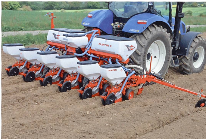
6-reihige Einzelkorn-Sämaschine mit Teleskoprahmen, Düngestreuer/Düngerschar und aufgebautem Mikrogranulatstreuer. (Werkbild)
