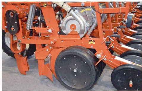
Die Mulchsaattauglichkeit hat zur Folge, dass das Säherz höher zu liegen kommt. Damit erhöht sich die Fallhöhe für das Korn. (Bild: Ruedi Hunger)
