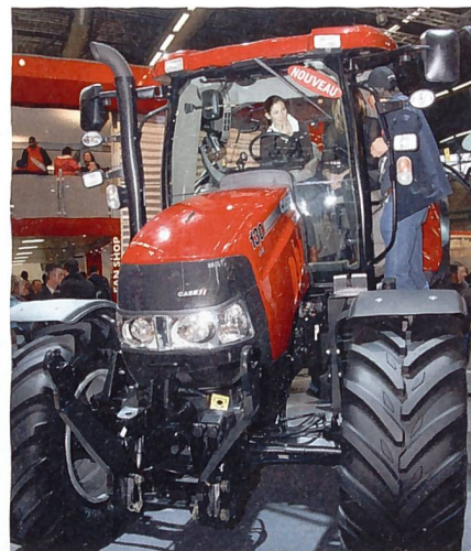
Die «Surround-Kabine» erreicht sehr gute Lärmwerte von lediglich 71 dB(A) am Fahrerohr. (Bild: Ueli Zweifel)
