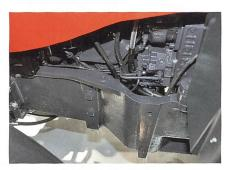
Gusshalbrahmen mit elastischer Motorlagerung bei den X7.6 Modellen.
