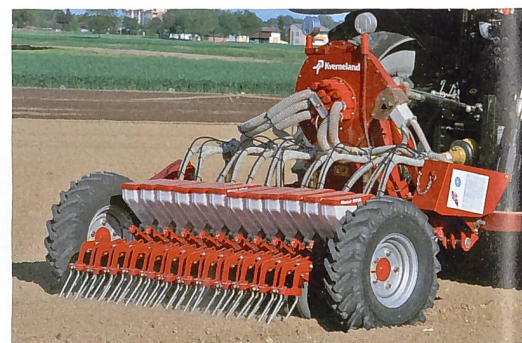
Für den Gemüsebau werden Einzelkorn-Sämaschinen mit extrem engem Reihenabstand gefordert. (Werkbild)
