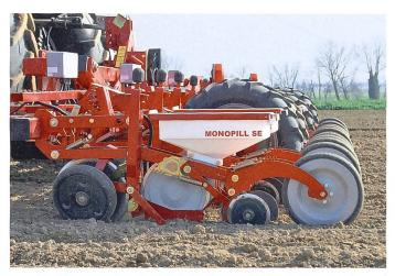
Die Säaggregatausrüstung ist auf eine möglichst gleichmässige Sätiefe ausgerichtet. Relativbewegungen im Bereich der Ablage sollen aufgefangen werden. (Werkbild)
