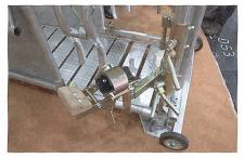
Fussstütze mit Gummiauflage. Eine verstellbare Auflage gibt zusätzlichen Halt.
