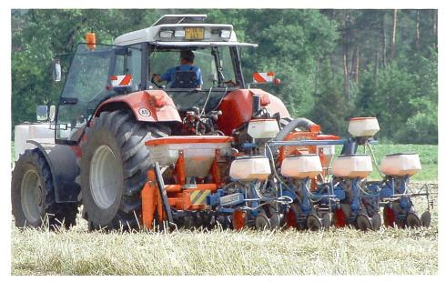
Für Streifenfrässaat stehen auf dem Schweizermarkt spezielle Bau- und Kombinationslösungen zur Verfügung.
