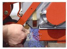
Eine einfache und rasche Entleerung des Saatgutbehälters ist Voraussetzung für eine saubere Saatguttrennung (Bio Saatgut!). (Werkbild)
