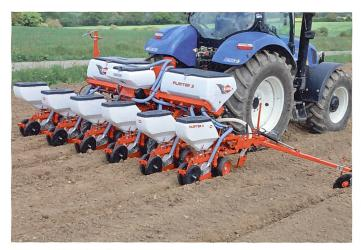
6-reihige Einzelkorn-Sämaschine mit Teleskoprahmen, Düngerstreuer/Düngerschar und aufgebautem Mikrogranulatstreuer. (Werkbild)
