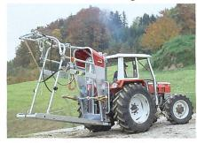
Der Klauenpflegestand «Top 5» von Rosensteiner weist eine einzigartige Bauart aus Rohren und Vierkantprofil auf. Das seitliche Entweichen wird durch aufklappbare Rohrbügel verhindert. Bei aufgeklapptem Bügel ist eine sehr gute Zu-
