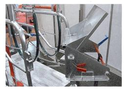
Hinterfussfixierung mit integriertem Kotauffangbecken.
