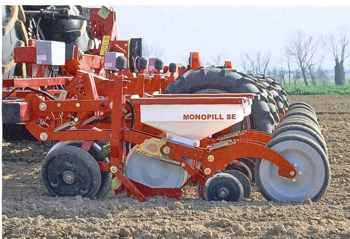
Die Säaggregatausrüstung ist auf eine möglichst gleichmässige Sättiefe ausgerichtet. Relativbewegungen im Bereich der Ablage sollen aufgefangen werden. (Werkbild)
