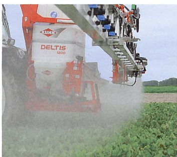
Beim Kuhn-Deltis-1200 wird jede Teilbreite von einem Elektropneumatikventil gesteuert. (Werkbild)
