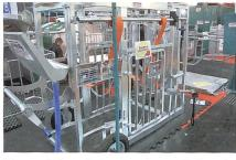
Dieser Behandlungsstand von Beiser ist mit 85 cm Durchgangsbreite für die Behandlung von grösseren Tieren geeignet. Das Tier wird mit einer verstellbaren Fangtür manuell fixiert. Die zwei Bauch-
