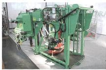
Der Klauenpflegestand Modell 800-1 ist das Fünfsterne-Modell des dänischen Herstellers KVK Hydra Klov. Dieses Modell bietet für die effiziente Klauenpflege mit grossem Durchsatz in vollhydraulischer Funktion mit einem 5,5-kW-Elektromotor, der alle Funktionen hydraulisch betätigt:
