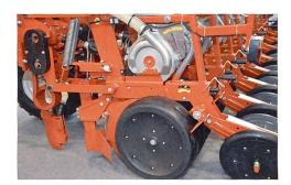
Die Mulchsaattauglichkeit hat zur Folge, dass das Säherz höher zu liegen kommt. Damit erhöht sich die Fallhöhe für das Korn.
