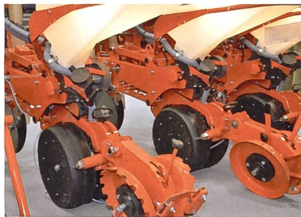
Damit Einstellungen von Tiefenführungsrollen und Andruckrollen vorgenommen werden, ist eine einfache Handhabung notwendig. (Bild: Ruedi Hunger)
