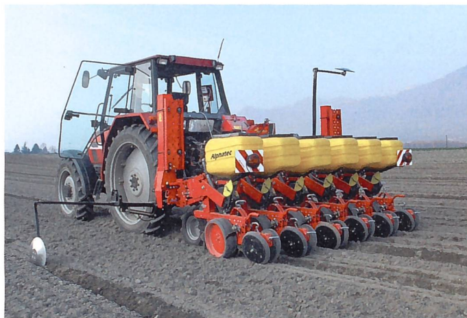
Auch bei der Einzelkorn-Sätechnik konnte die Flächenleistung nur über mehr Arbeitsbreite und/oder grössere Fahrgeschwindigkeit erreicht werden. (Werkbild)
