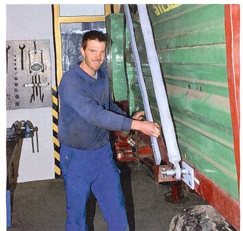
Adrian Stohler bei seinem Futterverteilwagen, der einen hydraulischen Ballen-Rückhaltebügel erhalten hat.
