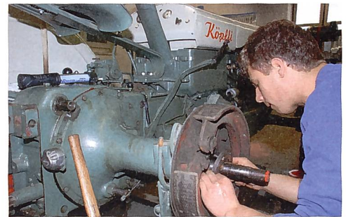
Fabian Wandeler tauscht Verbrauchsteile der Trockenbremse am Köppli-Traktor aus.
