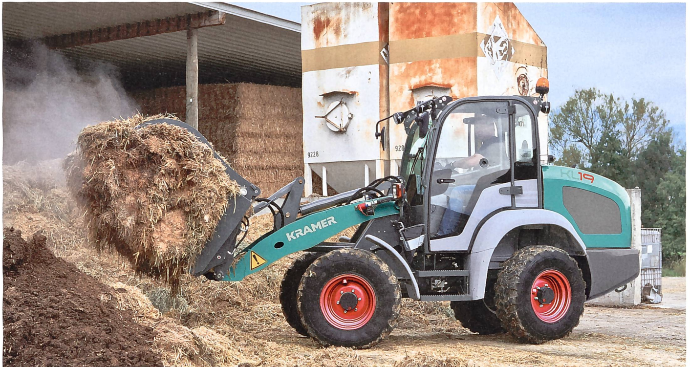
Der neue Lader von Kramer hat eine Vierradlenkung und ist daher standsicherer als ein Fahrzeug mit Knicklenkung. (Bilder BUL/ R. Burgherr)
