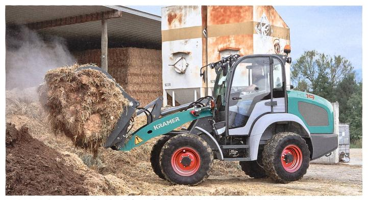
Der neue Lader von Kramer hat eine Vierradlenkung und ist daher standsicherer als ein Fahrzeug mit Knicklenkung. (Bilder BUL/ R. Burgherr)
