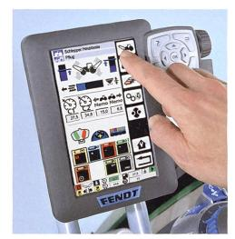
Beim neuen System Fendt Variotronic sind Bedienung der Maschine, ISOBUS-Gerätesteuerung, Spurführung VarioGuide, Kameradarstellung, Gerätespeicher, Vorgewendemanagement Variotronic TI und die Dokumentationslösung VarioDoc in einem Terminal integriert. (Foto: AGCO/Fendt)
