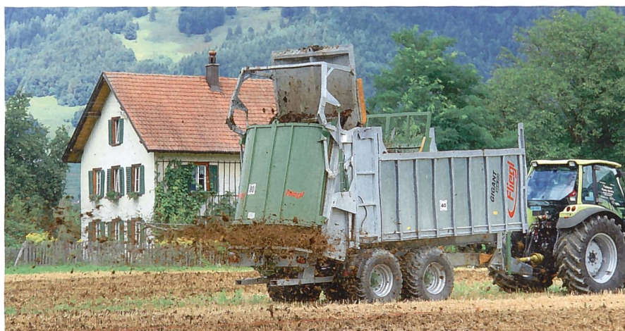
Mistzetter mit getrennten Fräswalzen und Streuteller können kleinere «Ladesünden» aufgrund ihrer Arbeitsweise ausgleichen.
