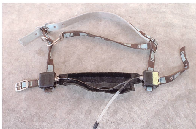
«RumiWatch»:- Nasenbandsensor: mit Flüssigkeit gefülltem Schlauch. Links und rechts sind die Elektronikkomponenten in wasserdichten Kunststoffboxen untergebracht.
