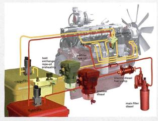
Die von Fendt und Deutz Ende 2007 vorgestellten Rapsöl-Traktoren waren mit Zwei-Tank-Systemen ausgestattet.
