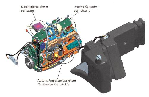
Beim Multi-Fuel-Traktor ersetzt die Motorelektronik sozusagen den zweiten Tank.
