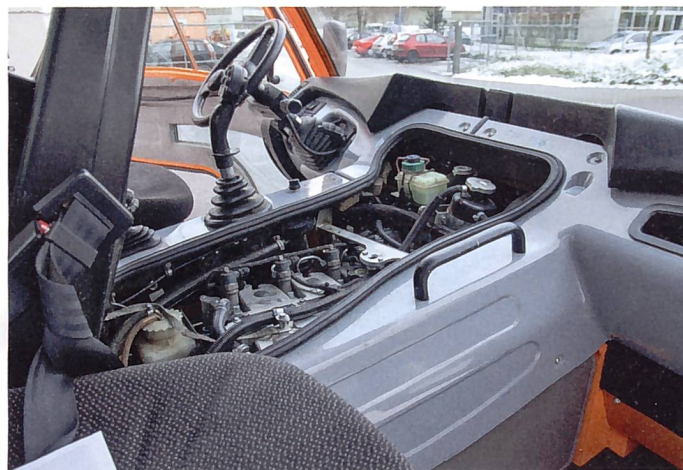
Der Motor ist über einen Deckel im Kabineninnern zugänglich, die Kühler können vorne am Fahrzeug gereinigt werden.
