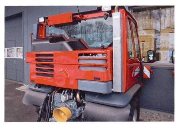
Die Hydraulikpumpen sind direkt am Getriebe angebracht, der Ölkühler über dem Getriebe. So sind die Hydraulikleitungen sehr kurz.
