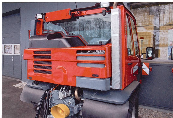
Die Hydraulikpumpen sind direkt am Getriebe angebracht, der Ölkühler über dem Getriebe. So sind die Hydraulikleitungen sehr kurz.
