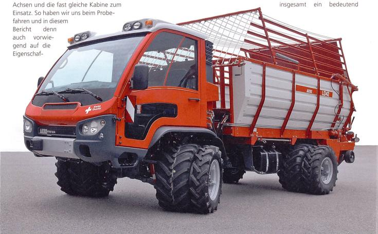
besserer Wirkungsgrad erzielt als mit einem reinen Hydrostaten. Arbeiten, welche langsame Geschwindigkeiten erfordern, sind ohne Zusatzinvestitionen in ein Kriechganggetriebe möglich. Dank Eco-Drive und hohem Getriebewirkungsgrad kann der Transporter wirtschaftlich betrieben werden. Diese Vorteile fallen desto mehr ins Gewicht, als der Aufpreis gegenüber dem handgeschalteten VT450 laut Aebi nur gerade etwas mehr als 3000 Franken beträgt!
