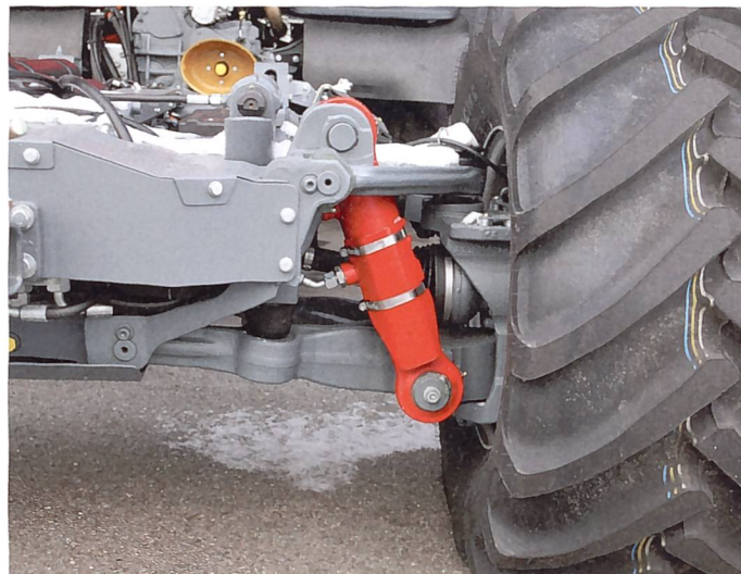
Die hydropneumatische Einzelradfederung nach dem Doppelquerlenkerprinzip hat einen Federweg von 100 mm und lässt sich blockieren.
