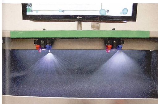
Unterschiedliche Tropfenbildung mit dem AmaSelect pro: Innerhalb einer Arbeitsbreite können Düsentypen mit unterschiedlichem Tropfencharakter bei gleichem Druck angesteuert werden.
