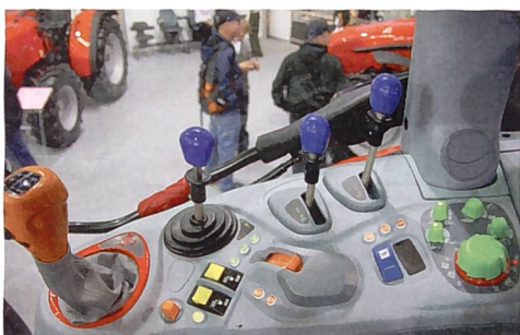
Die Farbgebung verschafft intuitiv die Übersicht über die Bedienelemente des Traktors.
