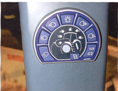
Zehn Arbeitsscheinwerfer werden über den sog. WOLP-Panel gesteuert.
