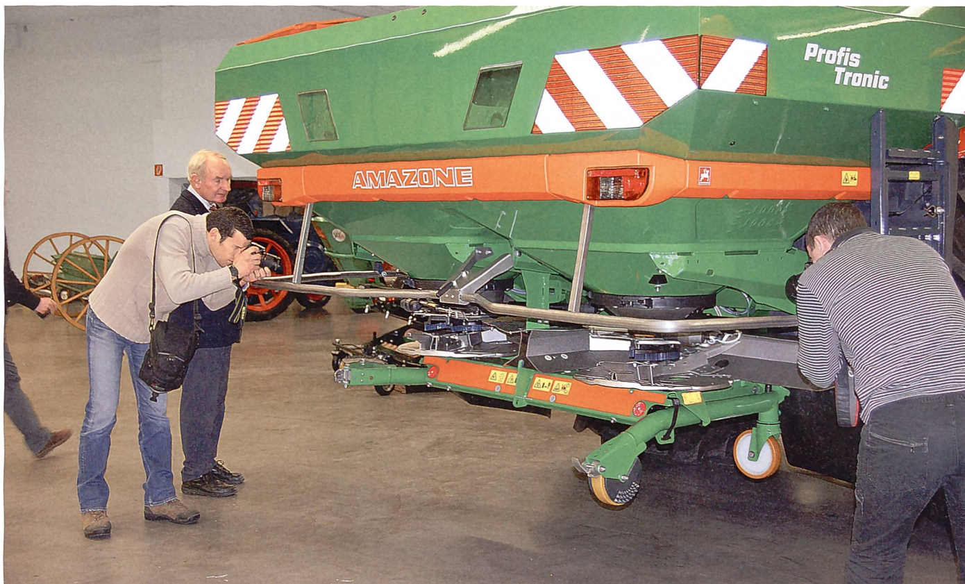
Kameras richten sich auf das neue Streuwerk des ZA-TS Profis. Man beachte insbesondere auch den Schutzrahmen und die abklappbare Roll- und Abstellvorrichtung. (Bilder: Ueli Zweifel)
