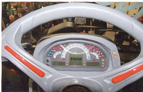
Auf dem übersichtlichen Display erhält der Fahrer Informationen sämtlicher Betriebszustände und Funktionen.
