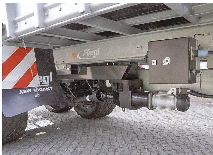
Fliegl Agrartechnik präsentierte die elektrische Triebachse «Power DriveElect» für Anhänger.
