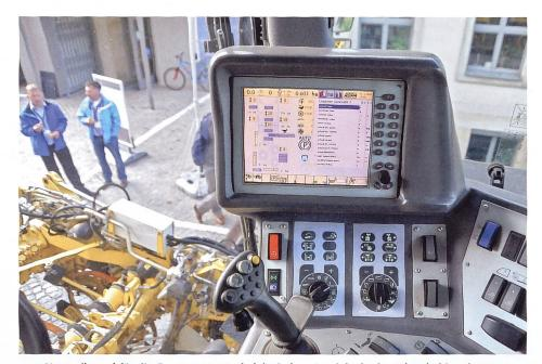
Kontrollpanel für die Generatoren und elektrischen Antriebe in der Fahrerkabine des Euro Tiger V8.
