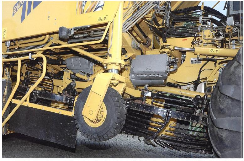
Die beiden grauen Aggregate am Rübenroder Euro Tiger V8 sind die hermetisch abgekapselten 150-kW-Elektromotoren für den Fahrantrieb. (Fotos: Carmen Rudolph)
