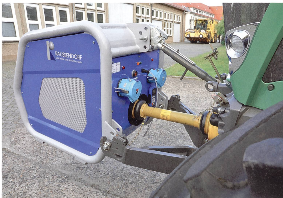
Generator-Nachrüstpakete mit integrierter Leistungselektronik – hier der PowerPack 45 von Raussendorf – sind eine interessante Zwischenlösung zur Bereitstellung von Energie für elektrische Antriebe.
