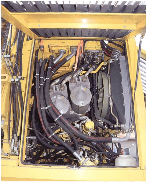
Zwei leistungsstarke Generatoren am Dieselmotor versorgen gemeinsam das Hochvolt-Bordnetz ...
