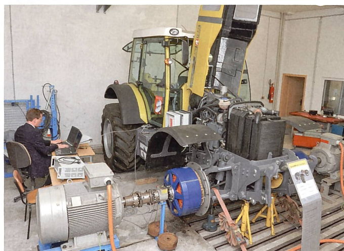
Der RigiTrac EWD 120 Diesel Electric mit vier Radnabenmotoren erhielt auf der Agritechnica 2011 eine Silbermedaille. An der TU Dresden werden gegenwärtig Tests durchgeführt, um die Steuerung der Antriebe weiter zu verbessern.
