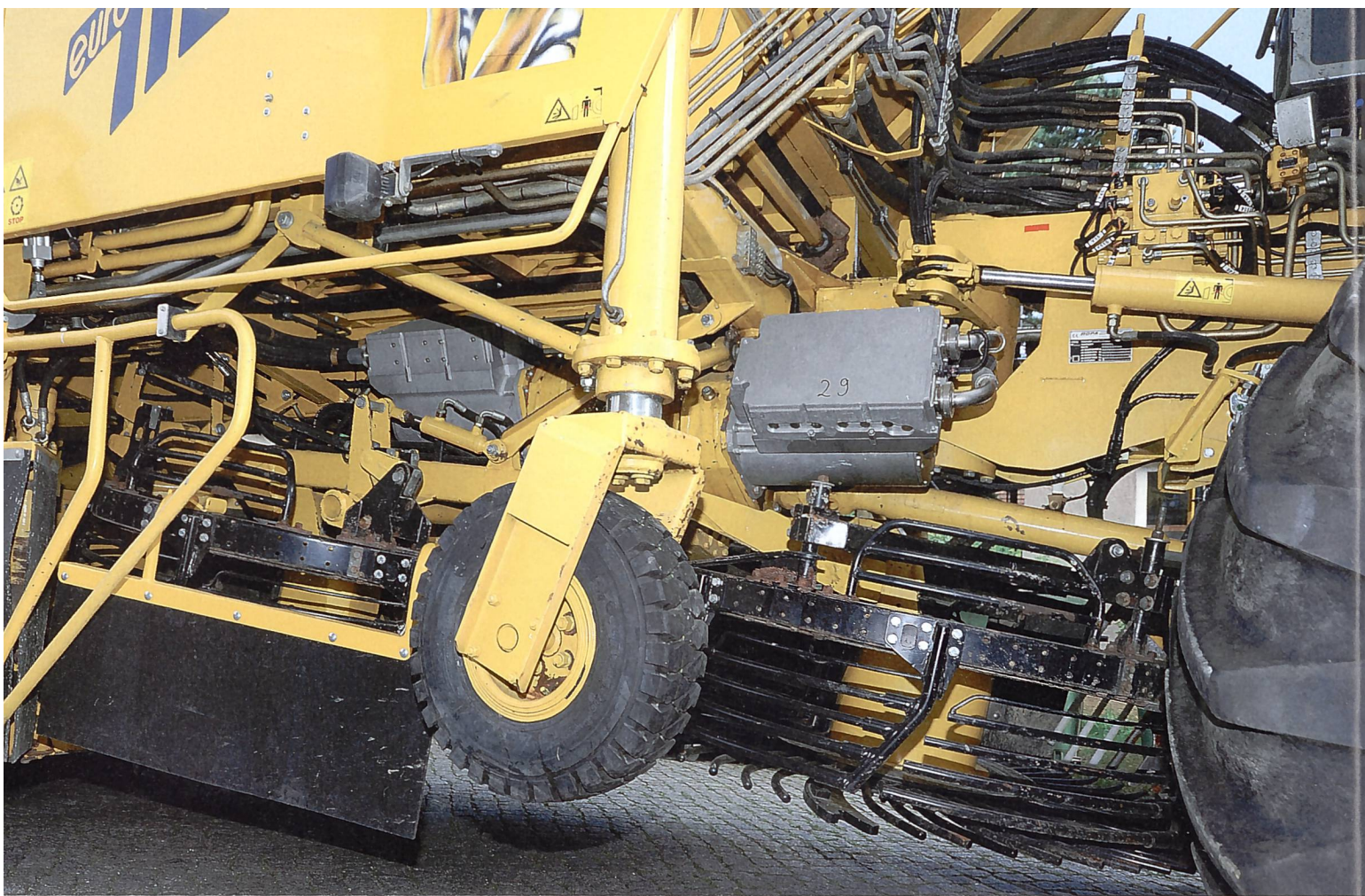
Die beiden grauen Aggregate am Rübender Euro Tiger V8 sind die hermetisch abgekapselten 150-kW-Elektromotoren für den Fahrtrieb. (Fotos: Carmen Rudolph)
