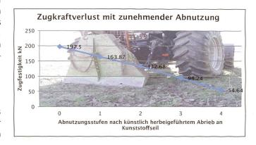
Damit möglichst rasch eine Antwort auf die Frage der Eignung von Kunststoffseilen gefunden wird, hat das BFW durch künstliche Abnutzung die Zugfestigkeit von Kunststoffseilen geprüft.
