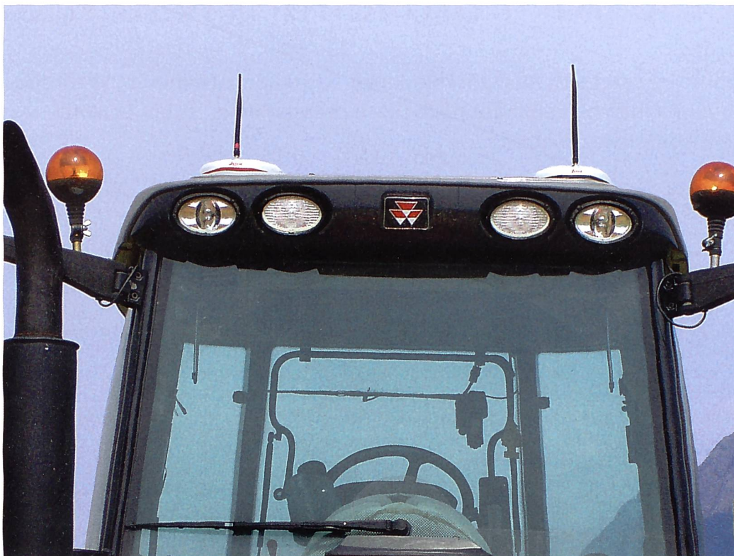
Wie sie sich gleichen und doch unterscheiden: Wenn ein Satellitensignal zur Positionsbestimmung verwendet wird, sind eine oder zwei Antennen unabdingbar.
