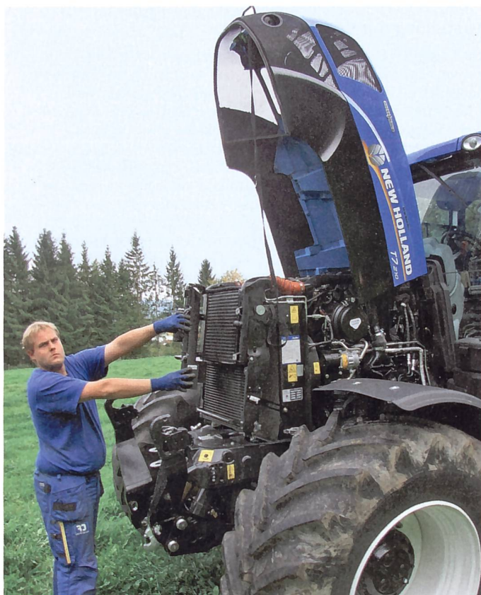
Die Haube lässt sich sehr weit aufklappen, und die Kühlerpakete können zum Reinigen herausgeklappt werden.
