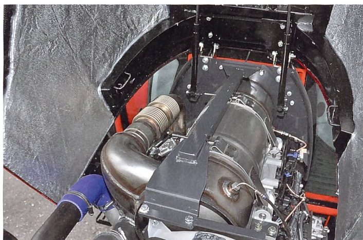
Gut für die Umwelt: Der Geotrac 134ep ist mit einem Dieselpartikelfilter plus Oxidations-Katalysator als geschlossenes System ausgerüstet und erfüllt damit die Abgasstufe IIIB.
