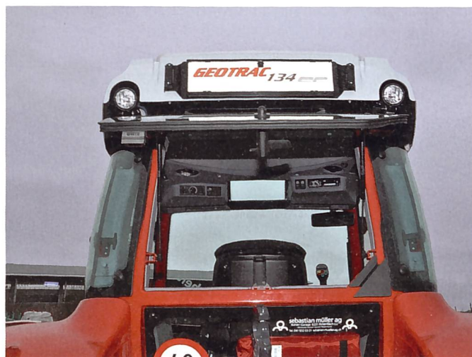
Beim Einlegen des Rückwärtsganges erscheint auf dem Innenspiegel das Bild der Rückfahrkamera. Auch die Navigationsanzeige erfolgt über den Innenspiegel.
