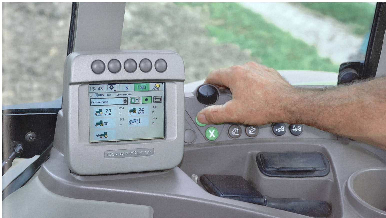
Automatische Spurführung, verbunden mit einem funktionierenden Vorgewende-Management, entlastet den Fahrer, sodass er sich auf Bearbeitungs- und Sätiefe sowie Maschinenüberwachung konzentrieren kann. (Bilder: Werkbilder/Ruedi Hunger)
