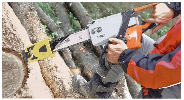
Der Fuss des Schärfgerätes wird gegen einen soliden Gegenstand gedrückt und die Säge mit voller Drehzahl laufen gelassen. (Bilder: WVS)
