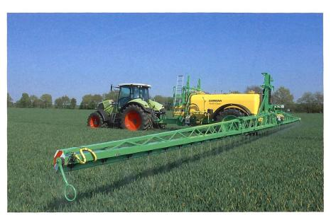
Durch ein gewisses Trägheitsmoment des Spritzbalkens werden horizontale und vertikale Bewegungen auch bei grossen Arbeitsbreiten kontrollierbar.
