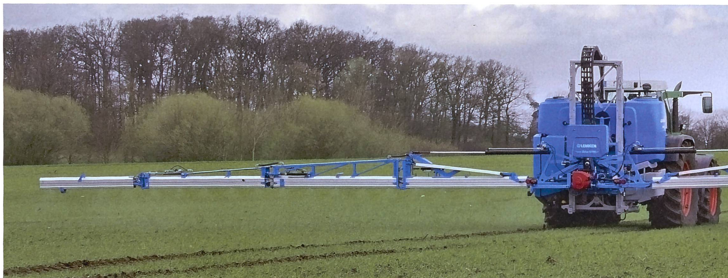
Mit Arbeitsbreiten von 24, 27, 30 oder gar 36 Meter nehmen die Belastungen für das Spritzgestänge stark zu. (Bilder: Werkbilder)
