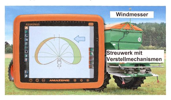
In Zusammenarbeit von Industrie und Wissenschaft entstand ein «Steuerungssystem» zum Ausgleich des Windeinflusses beim Einsatz von Zentrifugalstreuern.
