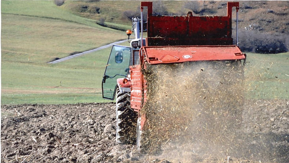
Rund zwei Drittel der Motorkraft werden vom Streuwerk beansprucht. Strohlänge, Durchsatzmenge und Bauart des Streuwerkes bestimmen den Leistungsbedarf. (Bild: Ruedi Hunger)
