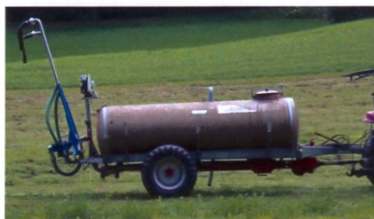
Bei der Fassversion werden die Schwenkarme für den Strassentransport hydraulisch nach oben geklappt.
