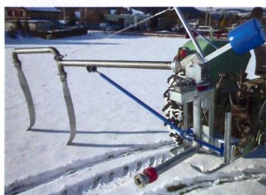
Walter Mai stellte mehrere Prototypen des Schleppschlauchverteilers her. Bei der ersten Version (ganz links) war der Schwenkarm noch auf einem Kugelkopfverteiler montiert. Im letzten Schritt wurde die Schlauchführung verbessert.
