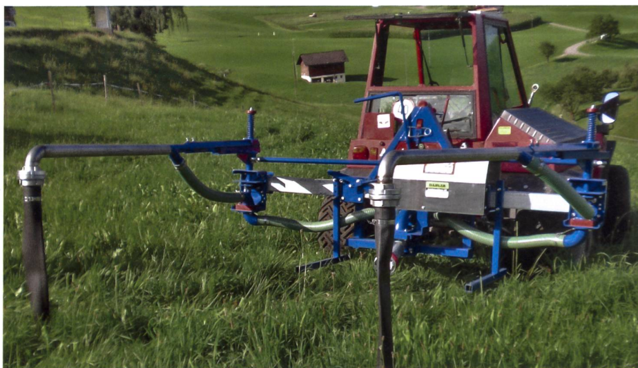
Der MAI Schleppschlauchverteiler ist auch für leichte Fahrzeuge geeignet. (Bilder: zVg)
