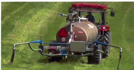
Bei der Fassversion werden die Schwenkarme für den Strassentransport hydraulisch nach oben geklappt.
