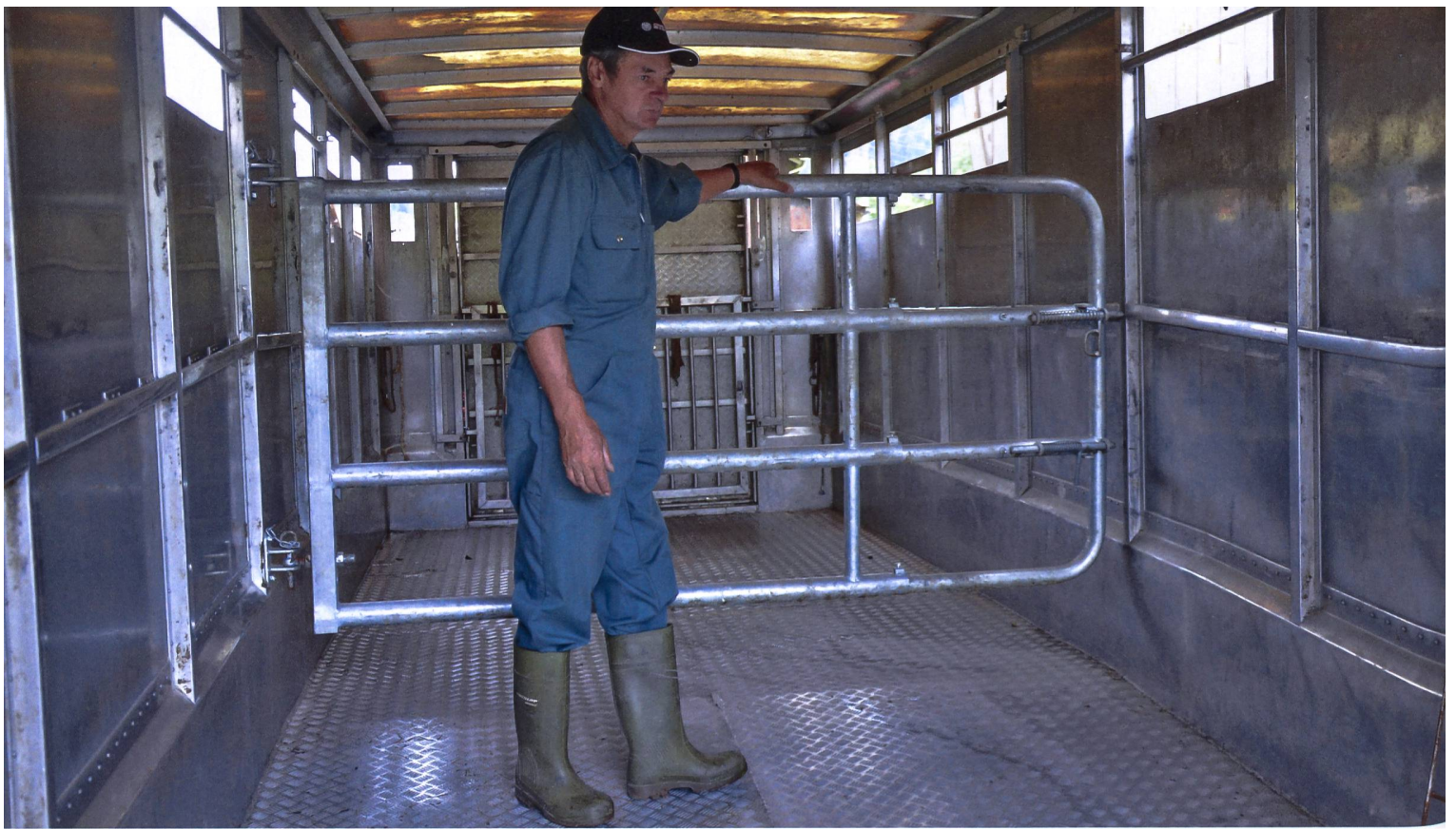
Mithilfe von Trenngattern können im Wagen kleinere Gruppen gebildet werden, und die Tiere verhalten sich ruhiger. (Bilder: Ruedi Hunger)
