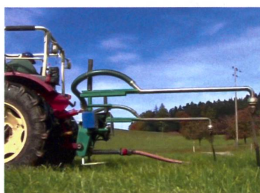
Walter Mai stellte mehrere Prototypen des Schleppschlauchverteilers her. Bei der ersten Version (ganz links) war der Schwenkarm noch auf einem Kugelkopfverteiler montiert. Im letzten Schritt wurde die Schlauchführung verbessert.
