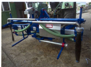
Die aktuelle Serienversion des Verteilers mit eingeklappten Armen.
