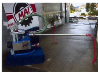
Walter Mai stellte mehrere Prototypen des Schleppschlauchverteilers her. Bei der ersten Version (ganz links) war der Schwenkarm noch auf einem Kugelkopfverteiler montiert. Im letzten Schritt wurde die Schlauchführung verbessert.
