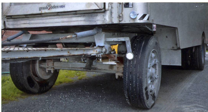
Eine grössere Plattformhöhe ist der Preis für grossdimensionierte Achsen und Räder. Dafür braucht es keine Radkästen.
