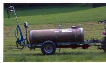
Bei der Fassversion werden die Schwenkarme für den Strassentransport hydraulisch nach oben geklappt.
