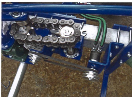
Über Stangen werden die Schwenkarme von einem Kettenglied in Bewegung versetzt.
