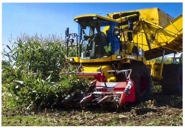
Das Verfahren Bunkerhäcksler hat einen tiefen Arbeitszeitbedarf und kurze Überladezeiten. Allerdings nimmt die Verfahrensleistung mit zunehmender Transportentfernung ab. (Bild: Ruedi Hunger)
