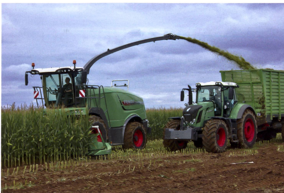
Typisch für schweizerische Verhältnisse: Häcksler und Abtransport direkt vom Feld zum Einsilieren. Noch eher untypisch die eingesetzte Erntemaschine: Das Bild stammt von der Präsentation des Katana-Feldhäcksler in Wadenbrunn (D). (Bild: Ueli Zweifel)
