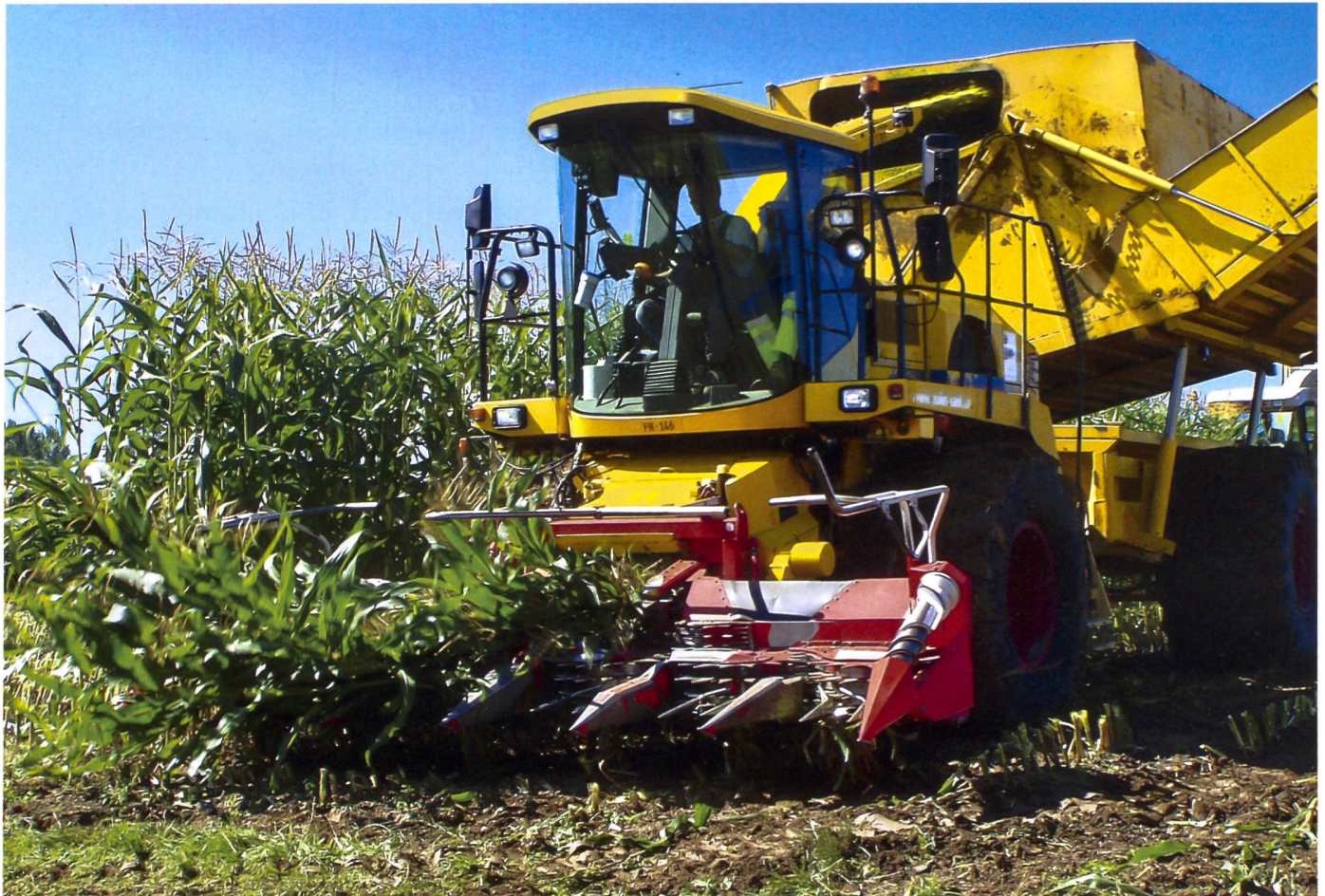
Das Verfahren Bunkerhäcksler hat einen tiefen Arbeitszeitbedarf und kurze Überladezeiten. Allerdings nimmt die Verfahrensleistung mit zunehmender Transportentfernung ab. (Bild: Ruedi Hunger)
