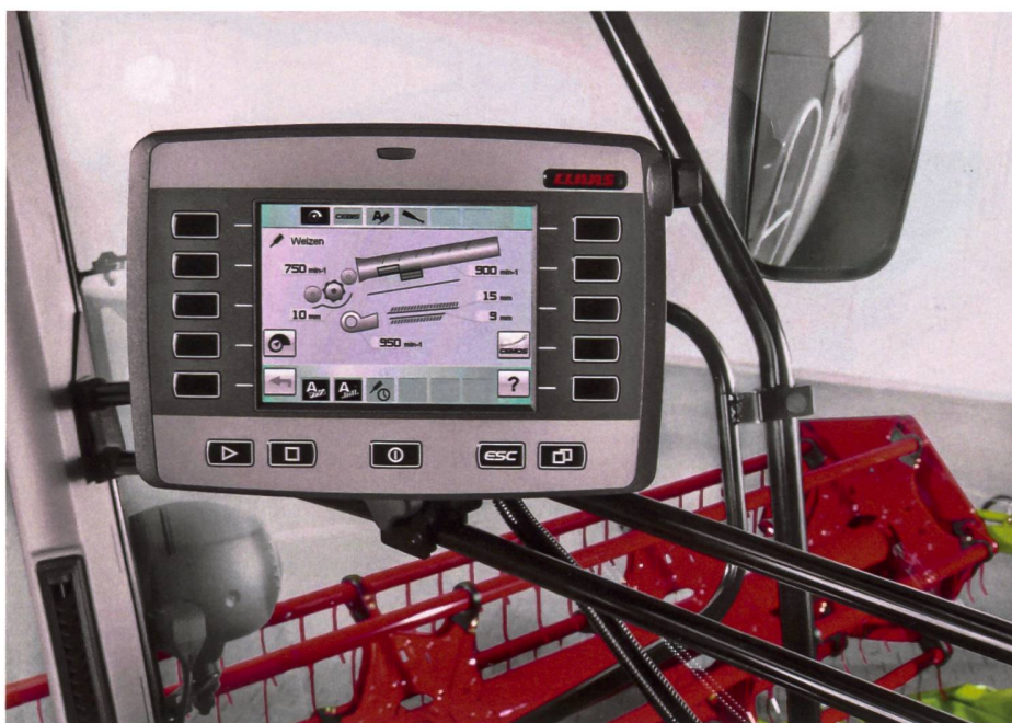
Die Automatikfunktionen werden dem Fahrer am Cebis-Terminal angezeigt.
