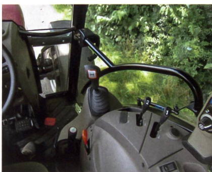
Haupt- und Gruppenschalthebel des Farmall C.
