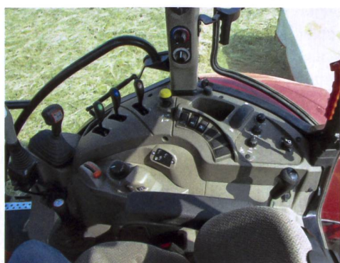
Die Bedienelemente des Farmall U.
