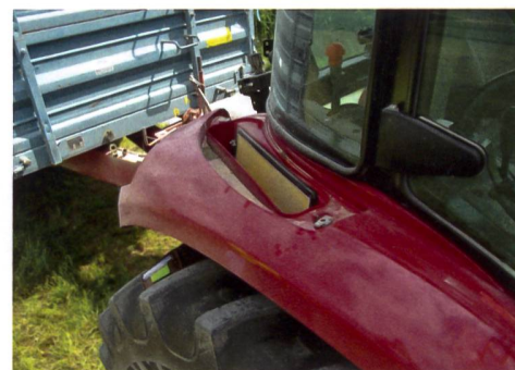
Die Kabinenluftfilter des Farmall C sind im Kotflügel gut zugänglich.
