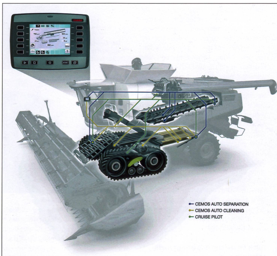
Das Elektroniksystem Cemos Automatic vernetzt die Systeme Cemos Auto Separation, Cemos Auto Cleaning und Cruise Pilot.
