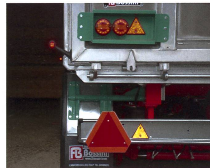
LED-Technologie: Hält länger bei geringerem Stromverbrauch.
