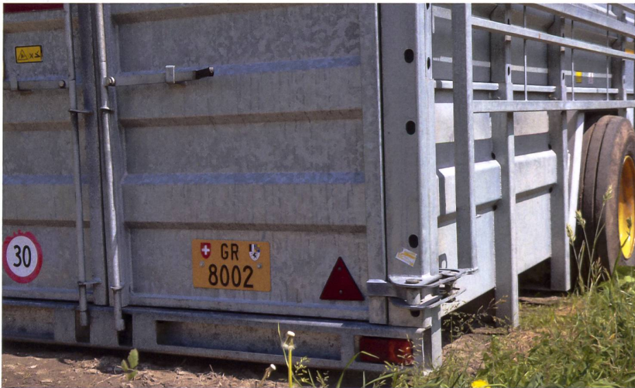
Eine bis auf den Boden abgesenkte Plattform und stets mitgeführte Seitengatter erleichtern das Ein- und Ausladen. (Bild: Ruedi Hunger)
