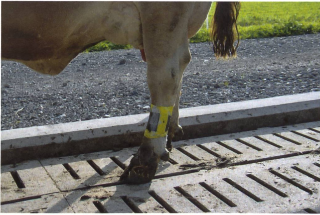
Abb. 2: Ein Beschleunigungsmesser, der am Bein der Kühe angebracht war, registrierte kontinuierlich, ob das Tier lag oder stand.
