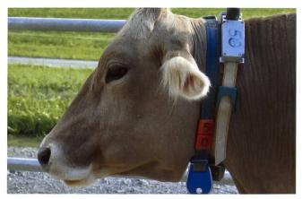
Abb. 3: Die Transponder auf dem Nacken der Kühe erlaubten es, deren Position im Stall mit Hilfe eines radarbasierten Ortungssystems kontinuierlich aufzuzeichnen und daraus die Nutzung der verschiedenen Stallbereiche zu ermitteln.
