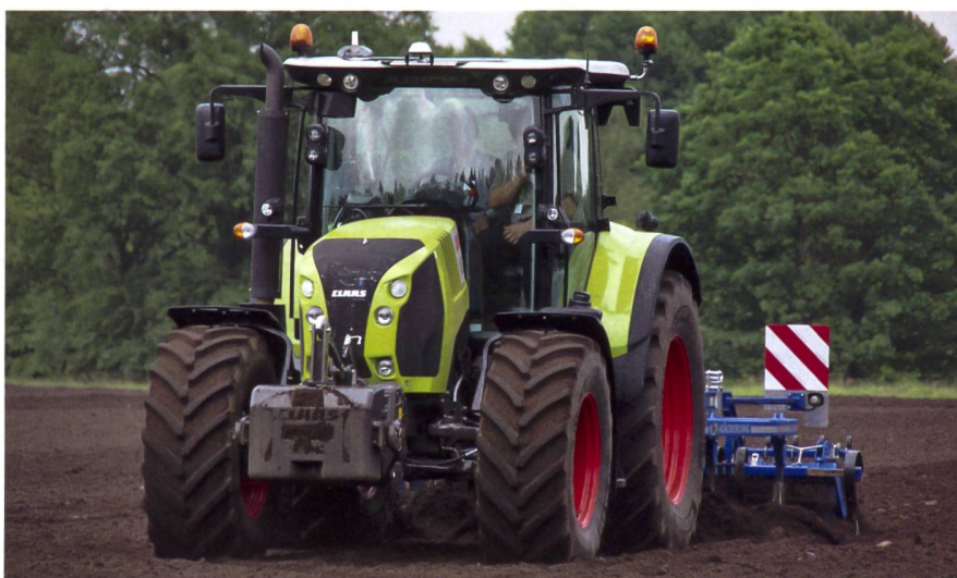
Typischer Ackereinsatz des Arion 650 unterwegs mit dem automatischen Lenksystem Claas GPS Pilot.
