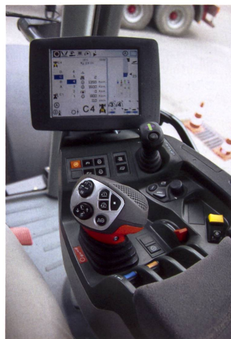
Cebis-Bedienkonsole mit Multifunktions-fahrhebel Cmotion
