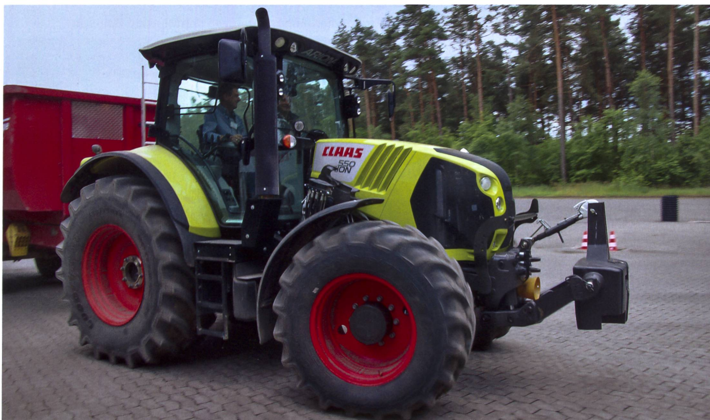
Arion 550 – stärkster Vierzylinder von Claas im Einsatz als Zugmaschine und ausgerüstet mit dem Halbrahmen für die Aufnahme der Konsolen von Frontlader und Fronthydraulik. (Bilder: Ueli Zweifel)
