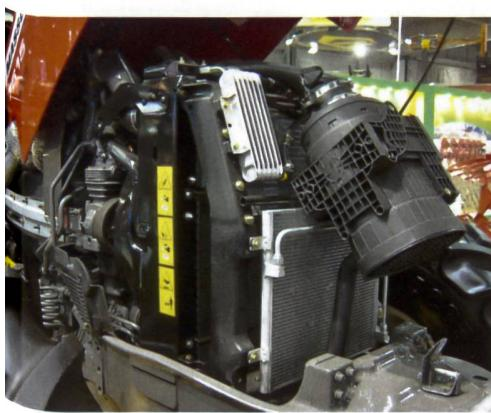
**Kühlerbatterie und Luftfilter wurden bei den MF 7600-Traktoren neu konzipiert, um die Zugänglichkeit von vorne zu verbessern. 90% vom Staub wird nach Angaben des Herstellers nach dem Venturi-Prinzip vor dem Filter herausgeholt.**
