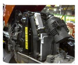
Kühlerbatterie und Luftfilter wurden bei den MF 7600-Traktoren neu konzipiert, um die Zugänglichkeit von vorne zu verbessern. 90% vom Staub wird nach Angaben des Herstellers nach dem Venturi-Prinzip vor dem Filter herausgeholt.
