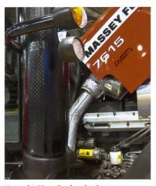
Unter der Motorhaube platziert: Dieseloxydationskatalysator (DOC)
