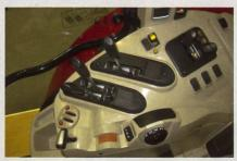
Besonderheit der Ausstattungsvariante Essential sind der T-Hebel sowie die an der Seitenkonsole angebrachte Bedienung der mechanischen Steuerventile.
