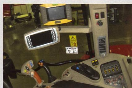
**In der Exclusive Version befinden sich an der Armlehne der Fahrhebel Multipad sowie der Joystick zur Bedienung der elektrischen Steuerventile.**
