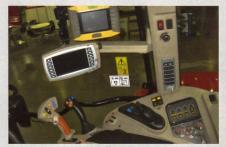
In der Exclusive Version befinden sich an der Armlehne der Fahrhebel Multipad sowie der Joystick zur Bedienung der elektrischen Steuerventile.
