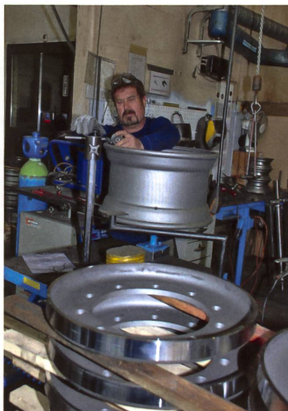
Jedes gefertigte Rad wird einzeln ausgemessen und protokolliert.
