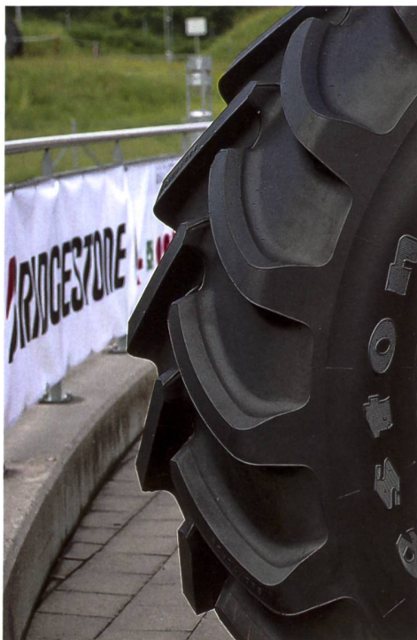
Der Firestone-Doppelwinkel-Stollen hat vorne dank 35-Grad-Winkel eine grössere Kontaktfläche.
