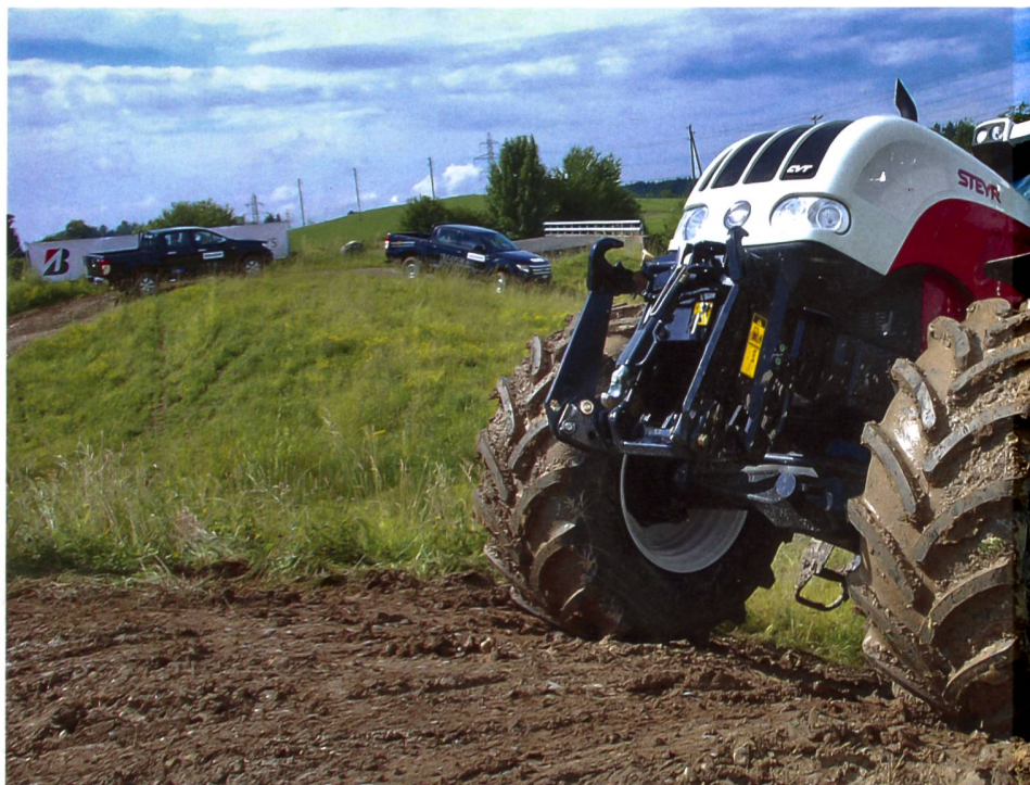
Dank Doppelwinkelstollen-Technologie beweist der Performer von Firestone auch im nassen Gelände gute Traktion und Selbstreinigung bei niedriger Bodenverdichtung.
