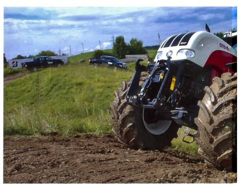
Dank Doppelwinkelstollen-Technologie beweist der Perfomer von Firestone auch im nassen Gelände gute Traktion und Selbstreinigung bei niedriger Bodenverdichtung.
