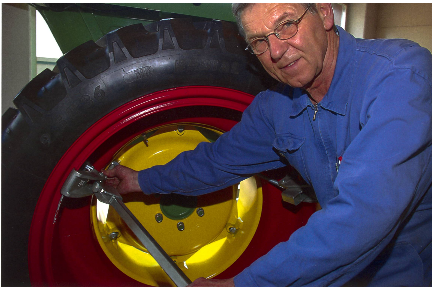
Mitgründer Rudolf Schaad zeigt das international patentierte System für Schnellverschlüsse. (Bilder: Dominik Senn)
