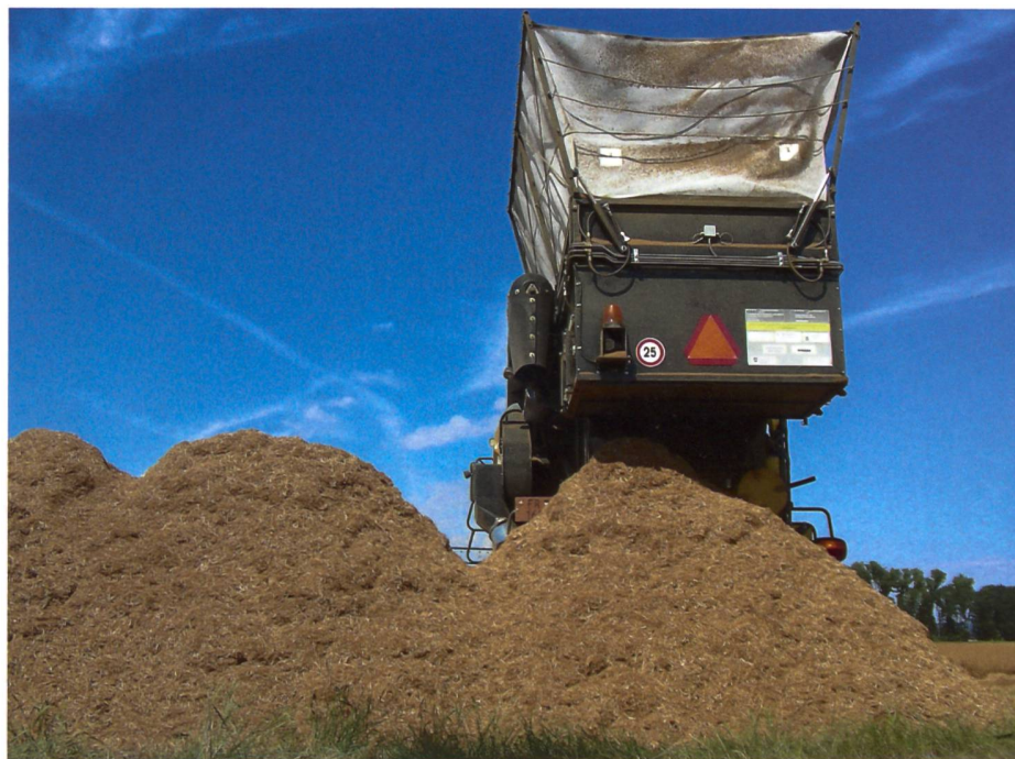
Dank dem faltbaren Bunker weist der HAFL-Spreusammler sehr kompakte Abmessungen auf.
