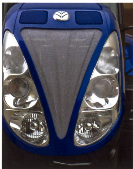
Die Lampenform wird heute vom Designer bestimmt. Dank moderner Bauart enthalten sie je nach Verwendungszweck Linsen-, Prismen- und kombinierte Elemente.
