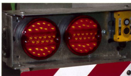
Teuer aber sinnvoll: LED-Technik an der Fahrzeugrückseite leuchtet heller und ist vor allem tagsüber besser sichtbar.
