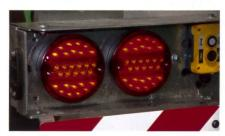
Teuer aber sinnvoll: LED-Technik an der Fahrzeugrückseite leuchtet heller und ist vor allem tagsüber besser sichtbar.
