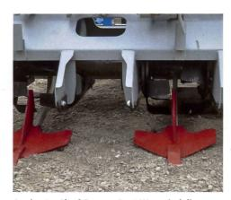
An der Streifenfräse von Beat Wyss sind die Grubberschare hinter der Welle befestigt.
