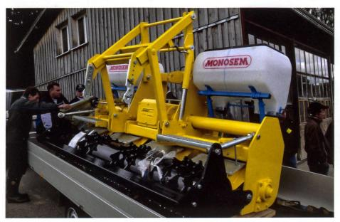
An der neuen Strebel-Streifenfräse sind viele Verschleissteile aus hartem Hardox-Stahl gefertigt.
