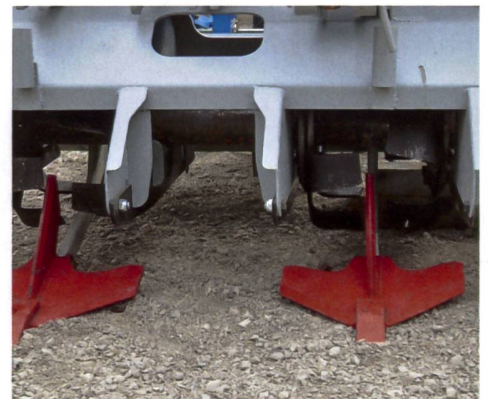
An der Streifenfräse von Beat Wyss sind die Grubberschare hinter der Welle befestigt.
