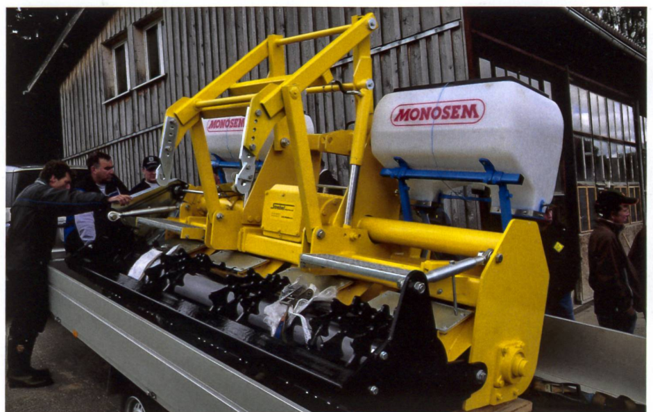
An der neuen Strebel-Streifenfräse sind viele Verschleisssteile aus hartem Hardox-Stahl gefertigt.
