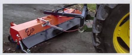
Eine Heckanbaumaschine schafft die Voraussetzungen für eine konsequente Strassenreinigung, da sie schnell angebaut ist.
