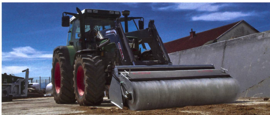
Eine Kombination von Bürste und Frontschaufel wird zum idealen Reinigungsgerät für befestigte Hofplätze, Feldwege und Strassen.
