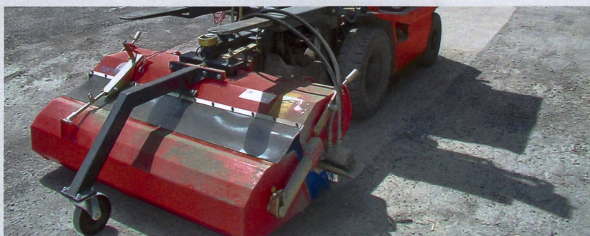
Der seitliche, hydraulische Antrieb steht über das Maschinengehäuse hinaus und muss deshalb geschützt werden.
