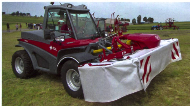
Das Alpinmäherwerk 260 FA ist für den Einsatz im Steilhang geeignet.
