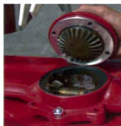
Der Balken der Splendimo Scheibenmäherwerke ist mit einer im Balken integrierten Antriebswelle ausgerüstet.
