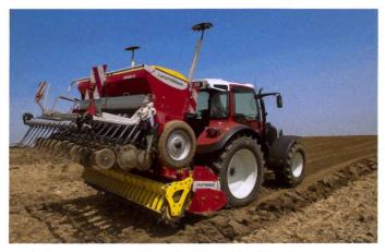
Durch das vorgängige Anheben der Sämaschine über das Anbaugerät wird die Vorderachse weniger stark entlastet.
