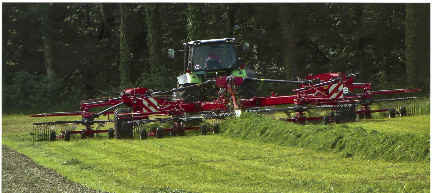
Der Hibiscus 1515 CD Profi ist mit einem einzigartigen, V-förmigen Fahrwerk ausgerüstet.
