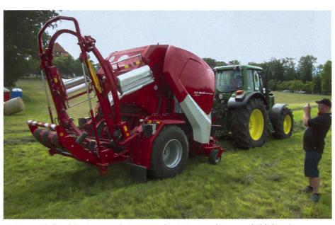
Die Presswickelkombination Tornado ist neu auch mit einer Festkammer erhältlich. Beim Pressen ist der Wickelring nach oben geklappt.
