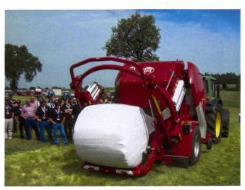
Beim Wickeln wird der Wickelring der Tornado waagrecht gehalten, für den Ballenauswurf wieder angehoben.
