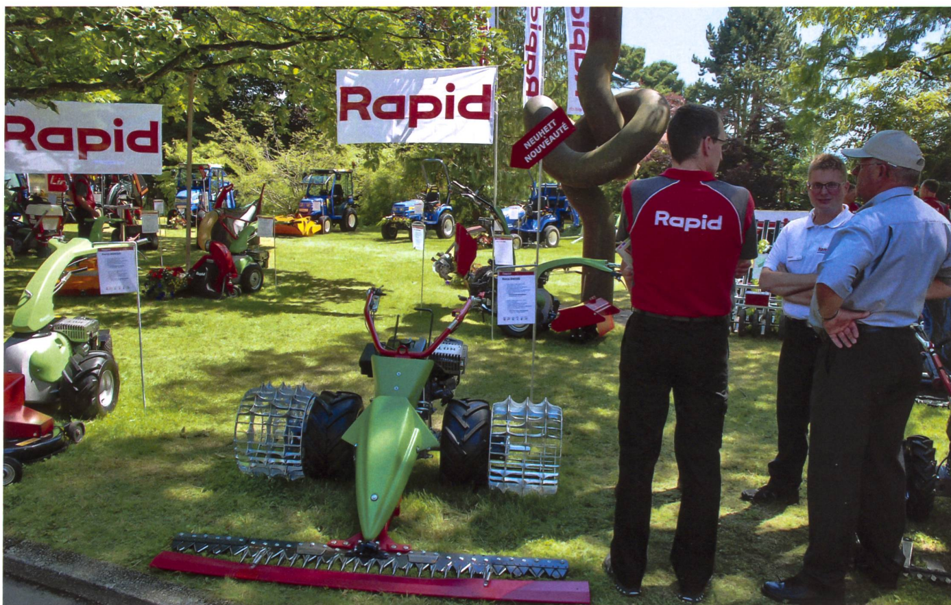
Ein Rapid Rex – der weltweit leichteste Bergmäher – an der Öga im lauschigen Park der Gartenbauschule Oeschberg BE; der tiefe Schwerpunkt und der hydrostatische Antrieb ermöglichen sicheres Mähen auch in kritischen Lagen. (Bilder: Dominik Senn)
