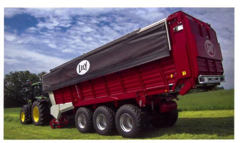
Der Ladewagen Tigo XR 100 mit Tridemfahrwerk ist eine imposante Erscheinung.
