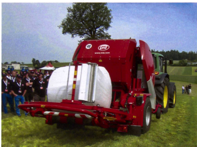
Beim Wickeln wird der Wickelring der Tornado waagrecht gehalten, für den Ballenauswurf wieder angehoben.
