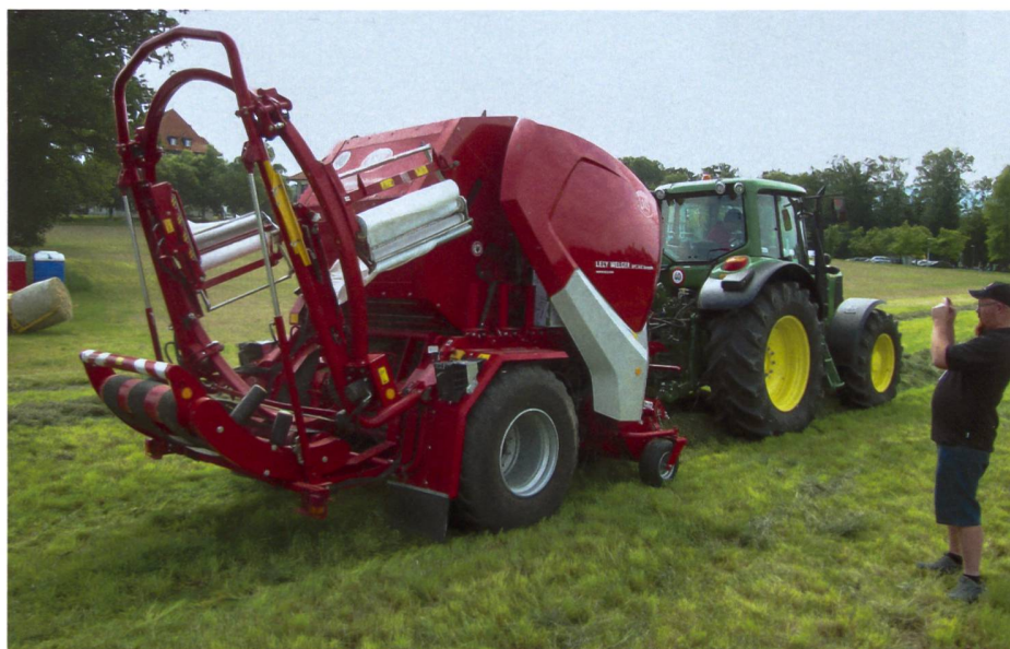
Die Presswickelkombination Tornado ist neu auch mit einer Festkammer erhältlich. Beim Pressen ist der Wickelring nach oben geklappt.
