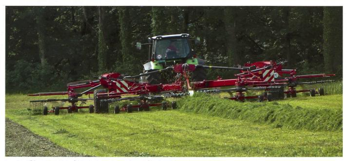
Der Hibiscus 1515 CD Profi ist mit einem einzigartigen, V-förmigen Fahrwerk ausgerüstet.
