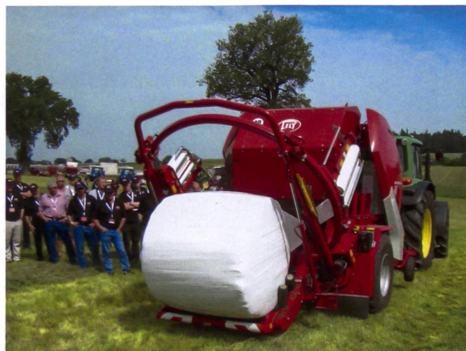
Beim Wickeln wird der Wickelring der Tornado waagrecht gehalten, für den Ballenauswurf wieder angehoben.
