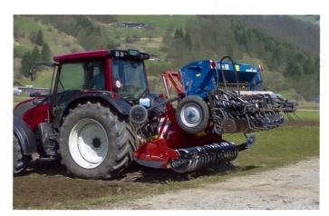
Säkombinationen belasten die Traktorhinterachse stark. Oft wird die Toleranzgrenze für Strassenfahrten erreicht.
