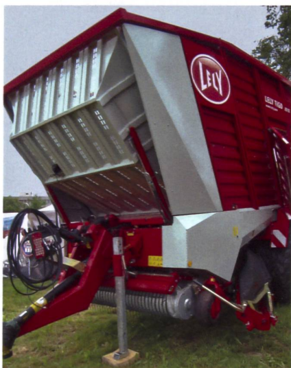
Die schwenkbare Stirnwand des Tigo ermöglicht es, den Pressdruck im Wagen der Futterart anzupassen.
