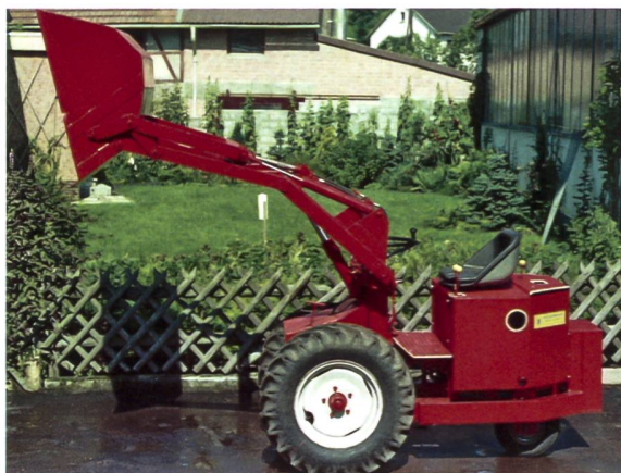
Die ersten Weidemann-Hoftrac-Prototypen wurden als Dreiradversion in der Praxis getestet.
