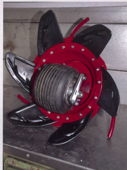
Seit 2011 ist das höhenverstellbare Tastrad des Kreisels auch als Pneurad erhältlich.
