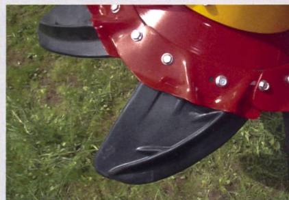
Durch die speziell geformte Gummimanschette erfolgt das exakte Trennen des Futters.
