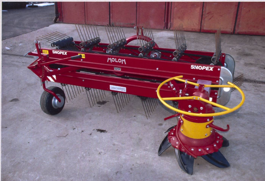
Der patentierte Kuriger-Kombiheuer ist an alle gängigen Marken von Bandheuern anbaubar. Der gelbe Futter-Abweisbügel ermöglicht auch gezieltes Heranfahren an Hindernisse.
