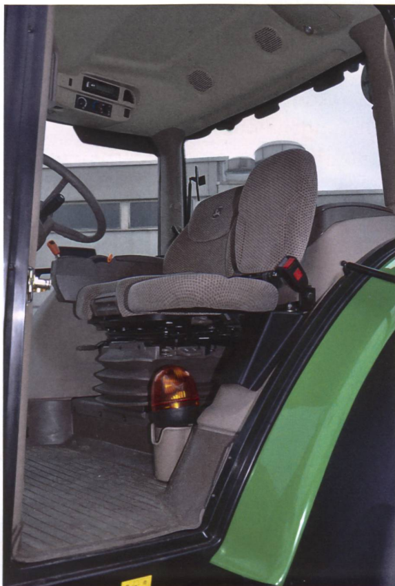
Beim DLG-Fokus-Test werden u.a. die vertikale Beschleunigung des Fahrers sowie der Aufwand zur Sitzeinstellung und der allgemeine Fahrkomfort beurteilt.
