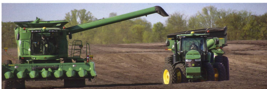
MachineSync: Über die Elektronik lotst der Mähdrescherfahrer den Traktorzug zum Abtanken heran und positioniert den Transportanhänger für die gleichmässige Befüllung und dem Kornauswurf.
