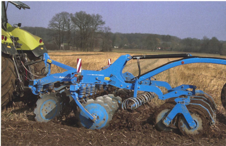
Bei einer Arbeitstiefe von 20 Zentimetern müssen dem Rubin Traktoren ab 150 kW vorgespannt werden. (Bild: Lemken)
