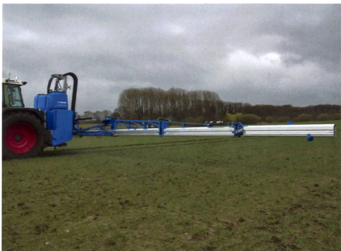
Das Aluprofil verleiht Stabilität und bietet dem 5-fachen Düsenträger mit Einzeldüsensteuerung optimalen Schutz.
