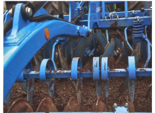
Die Scheiben sind so angeordnet, dass keine Problemzone «Mitte» mehr vorhanden ist.
