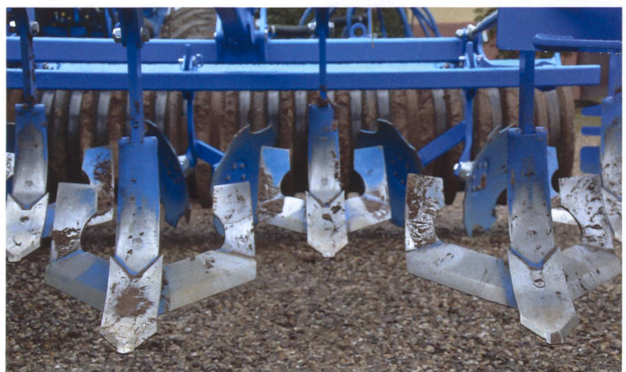
Die neue TriMix-Schar verbessert das Mischen von Erde und Ernterückständen.
