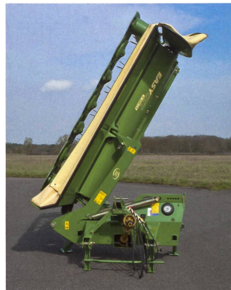
Die Heckmäherwerke lassen sich dank guter Gewichtsverteilung in der Transportposition auch äusserst platzsparend einstellen.
