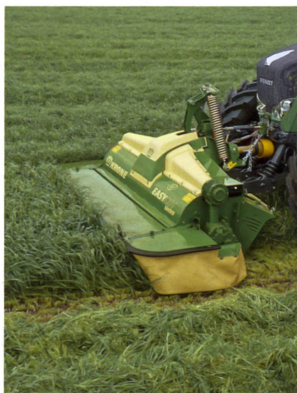
Die neue «EasyCut»-Scheibenmäherwerk-Generation hat ein abgerundetes Design und einen gummierten Anfahrerschutz erhalten. (Bilder: Ruedi Burkhalter)
