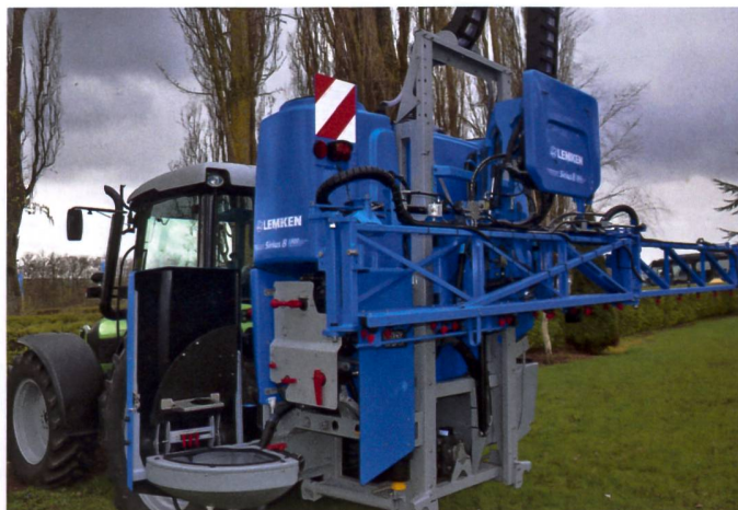
Die Sirius 8 unterscheidet sich von der Baureihe 10 in erster Linie durch den Automatisierungsgrad und, hier auf dem Bild ersichtlich, durch das optimierte, aber herkömmliche Spritzgestänge.
