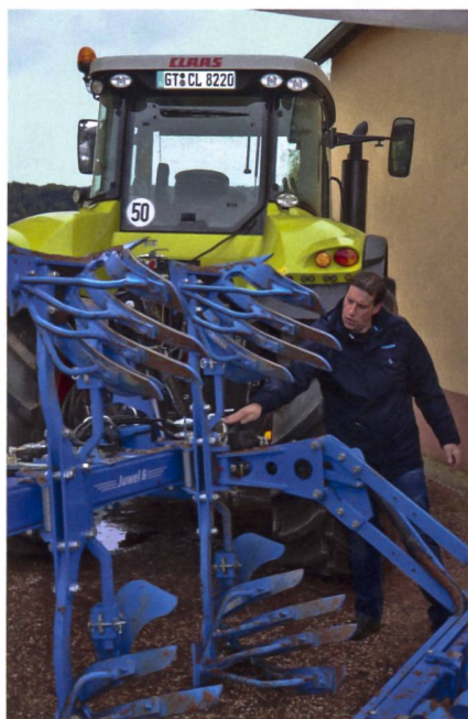
Ab Sommer 2012 ist der FlexPack am Juvel 8 mit mechanischer Bruchssicherung erhältlich.
