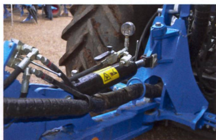
Mit einem Traktionsverstärker wird die Traktorhinterachse zusätzlich belastet, folglich reduzieren sich Schlupf und Treibstoffverbrauch.
