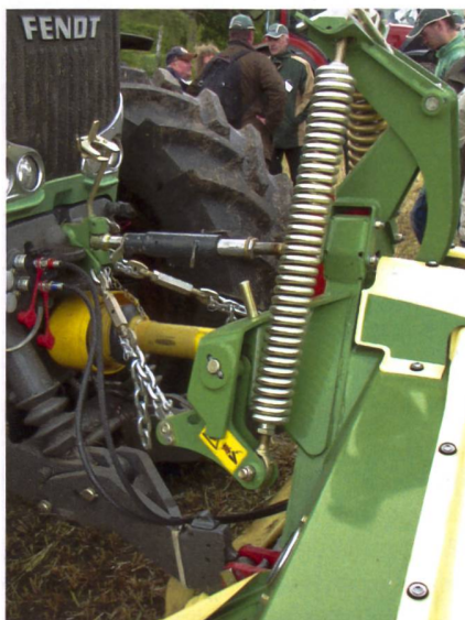
Neu gestalteter Anbaubock der Frontmäherwerke mit hydraulisch verstellbarer Vorspannung der Entlastungsfedern als Option.
