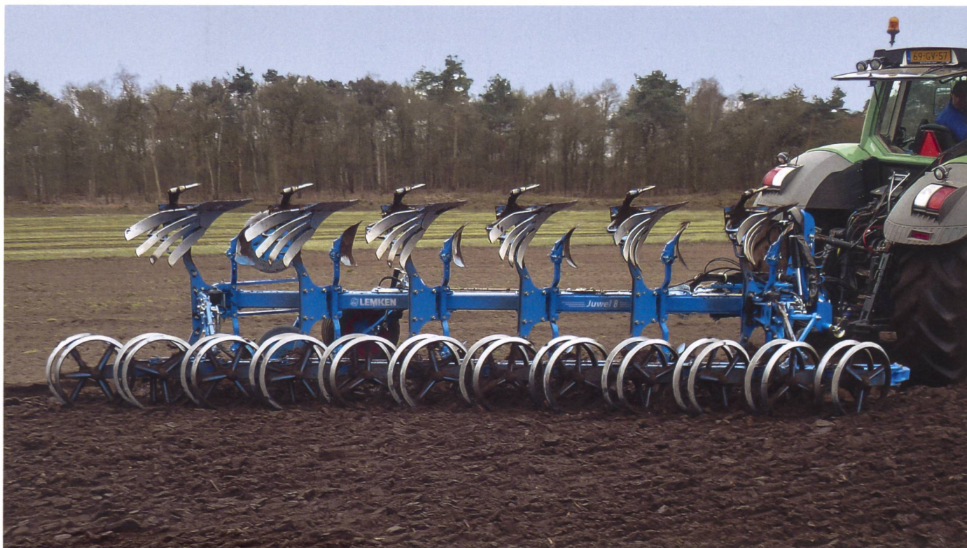
Der FlexPack passt seine Arbeitsbreite automatisch derjenigen eines Variopflugs an. (Bild: Lemken)
