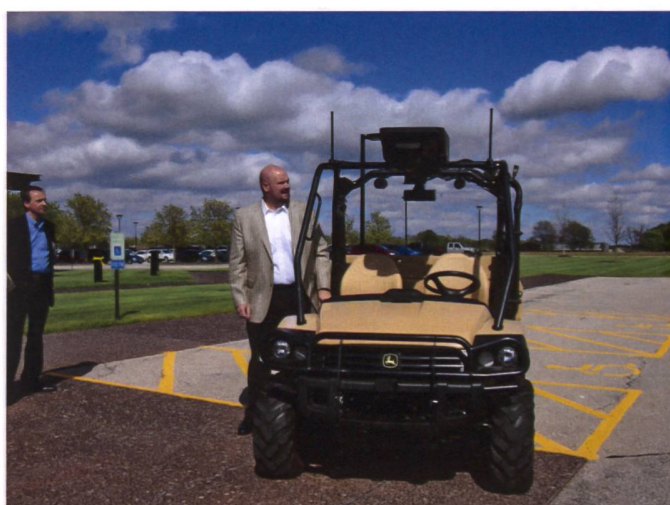
Versuchsobjekt beim Forschungszentrum von Moline: Vollgepackt mit Elektronik, Satellitenortung, Korrektursignal und Infrarotsensorik findet dieses Fahrzeug automatisch und ferngesteuert den Weg von A nach B. Es stoppt vor Hindernissen oder weicht ihnen aus.
