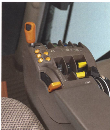
DirectDrive-Bedienkonsole: unverkennbare Ähnlichkeiten zum stufenlosen AutoPower-Getriebe.
