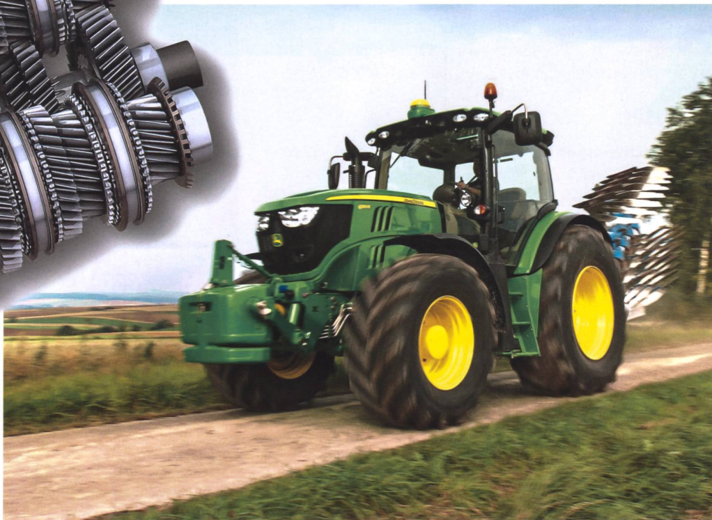
DirectDrive: Getriebe mit acht Lastschaltstufen und Doppelkupplungstechnik.
