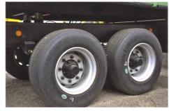
Reifeninnendruck und Tragfähigkeit gemäss Reifenhersteller sind entscheidend für die Lebensdauer eines Reifens bei Strassentransporten. Lange Zeit unbenützte Anhänger müssen speziell gut kontrolliert werden.
