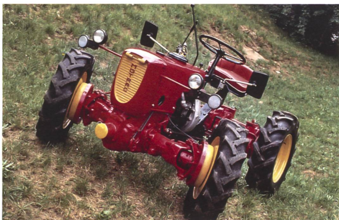
Motrac entwickelte aus dem Einachser einen Kleintraktor mit Allradantrieb, Vierradlenkung und Vierradbremssen. (Bilder: zVg)
