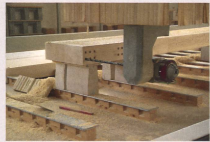
Eine moderne CNC-Anlage bohrt Löcher in Holzteile, welche mit Gewindestangen aus Stahl verbunden werden.
