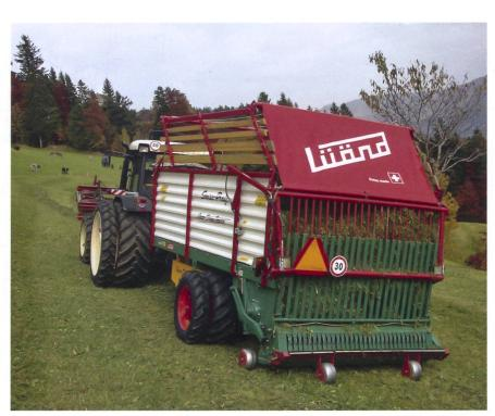
Der Lenktriebachsanhänger am Traktor ist eine Alternative zum Transporter.
