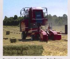
Der kanadische Hersteller des «Bale Baron» bietet die Maschine, die an der Hochdruckpresse angehängt oder mit einer Aufnahme betrieben wird, in drei Varianten für Pakete mit 21, 18 oder 9 Ballen aus unterschiedlichen Presskanälen an. Die Maschinen arbeiten mit liegender Bindekammer mit Garn und Knotern von Hesston. Bei allen drei Varianten werden drei Ballen aufeinandergestapelt:
