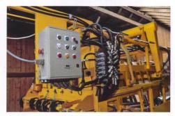
Die automatische Steuerung der Maschine ist in einem Schaltkasten neben dem hydraulischen Steuerblock angeordnet.
