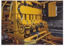
Die vier Knoter der Bindemaschine funktionieren nach dem gleichen Prinzip wie bei einer normalen Grossballenpresse.
