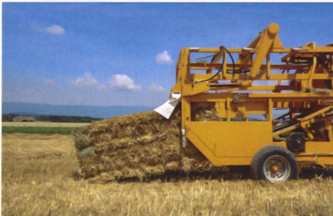
Ohne anzuhalten rutscht das Ballenpaket aus der Bindekammer. (Bild: Heinz Rötliberger)
