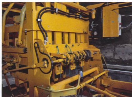
Die vier Knoter der Bindemaschine funktionieren nach dem gleichen Prinzip wie bei einer normalen Grossballenpresse. (Bild: Ruedi Burkhalter)
