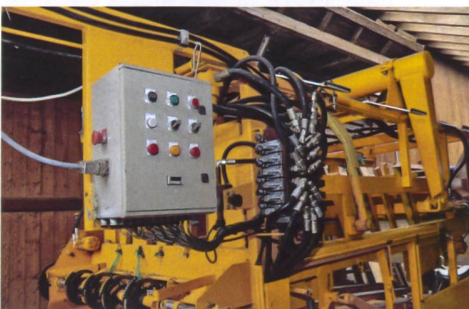
Die automatische Steuerung der Maschine ist in einem Schaltkasten neben dem hydraulischen Steuerblock angeordnet. (Bild: Ruedi Burkhalter)
