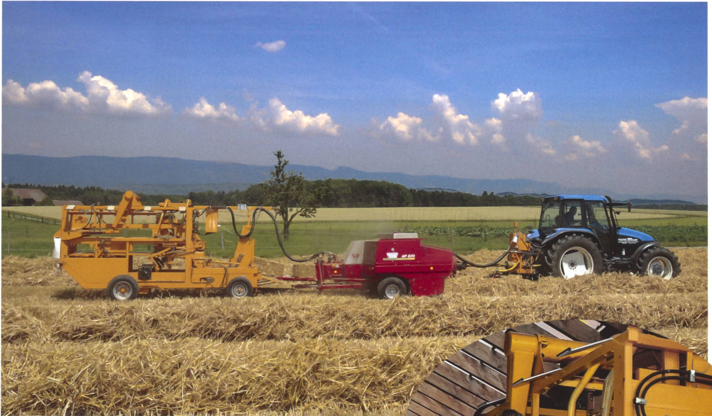
Urs Ruchti setzt den Ballenbinder direkt hinter der Presse ein. Das gesamte Gespann ist über 16 Meter lang. Die Hydraulikpumpe ist zwischen Traktor und Kleinballenpresse eingebaut.
