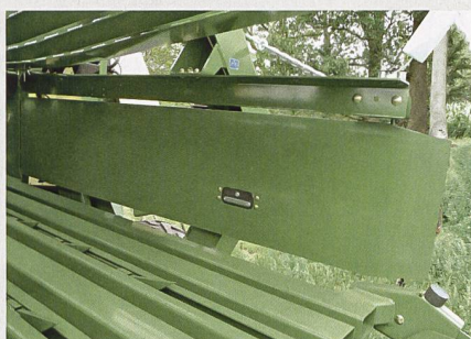
Dank Sensoren wie diesem Feuchtesensor im Presskanal kann der Einsatzkoordinator das Resultat der Arbeit überwachen.
