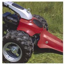
Doppelbereifung verbreitert die Spur und erhöht die Auflagefläche; zudem kann problemlos über Strassen und Feldwege gefahren werden.
