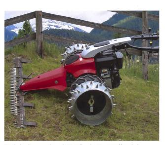
Stachelwalzen werden mit Metall- oder Kunststoffstacheln ausgerüstet.
