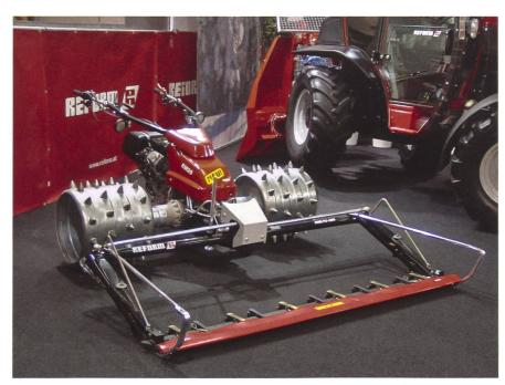
Reine Stachelwalzen sind ausschliesslich auf gewachsenem Boden und - bedingt - auf unbefestigten Feldwegen einsetzbar.
