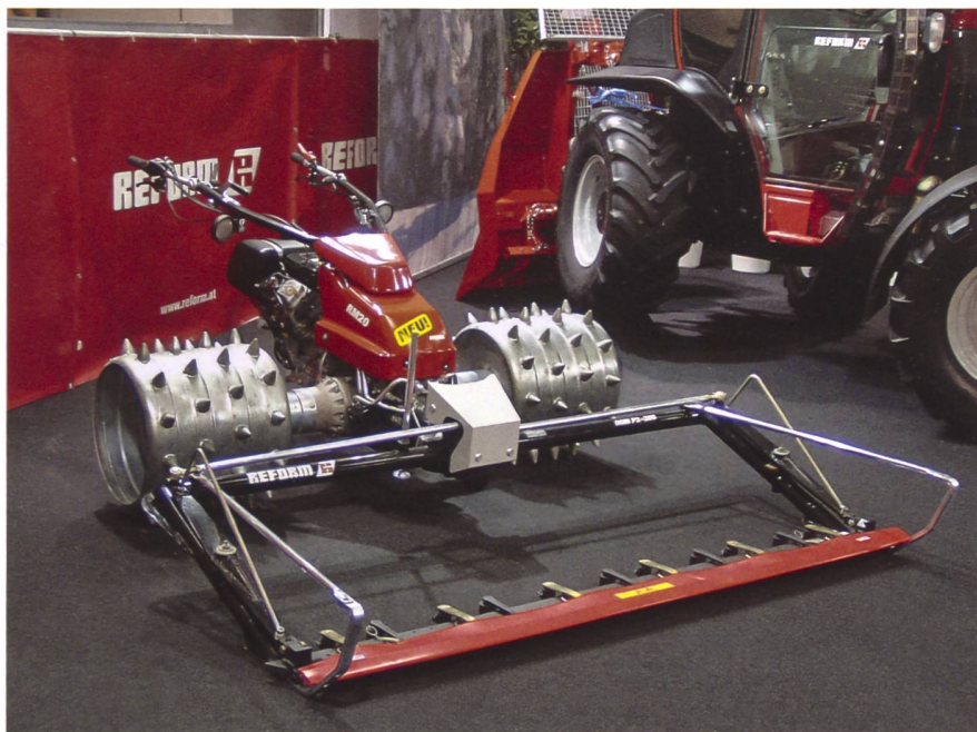
Reine Stachelwalzen sind ausschliesslich auf gewachsenem Boden und - bedingt - auf unbefestigten Feldwegen einsetzbar.
