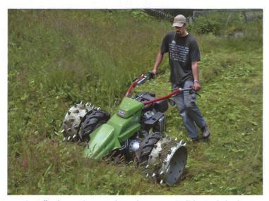
Anstelle eines weiteren Rades verbessern zusätzliche Stachelwalzen die Hangsicherheit (weniger abrutschen).
