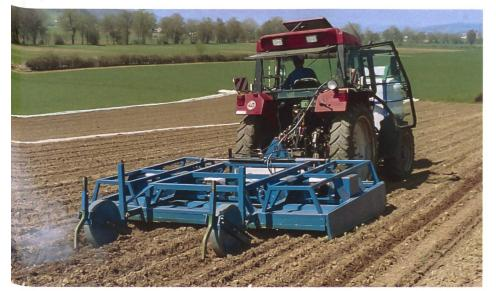
Im Gemüsebau ist das ganzflächige Abflammen im Vorauflauf besonders bei Karotten weit verbreitet. Das Abflammgerät StfFG1.5/3.0SG (Schaffner Terra Tech AG, Oensingen) hat mit den beiden hydraulisch klappbaren Seitenteilen von je 0,75 m eine Arbeitsbreite von 3 m. (Foto: zVg)
