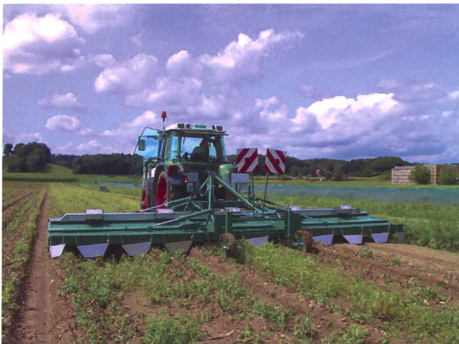
Abflammen von Kartoffelstauden (Modell STfFG7.5LG, Schaffner Terra-Tech AG, Oensingen, 7,5 m Arbeitsbreite, Gasverbrauch 100 kg/h, Geschwindigkeit 2–5 km/h, Gewicht 1400 kg).
