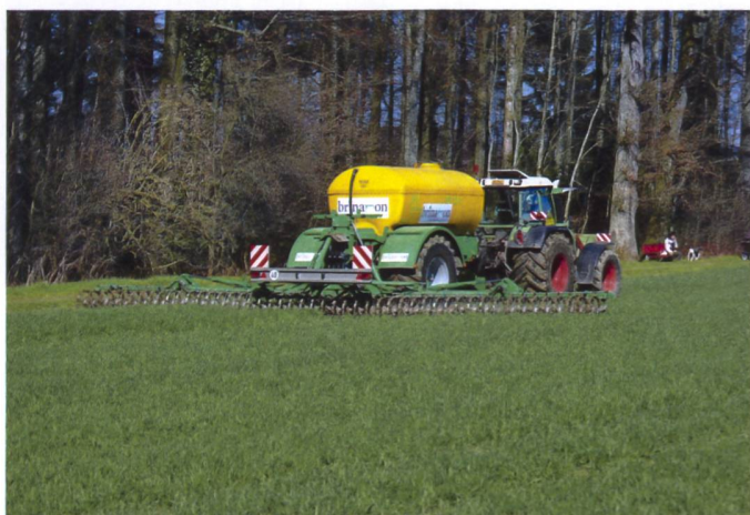
Die Cultan-Maschine von Güstrow hat eine Arbeitsbreite von 12 m und eine Leistung von etwa zwei Hektaren pro Stunde.
