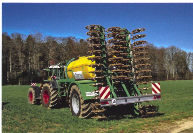
Für den Strassentransport der Maschine kann der Balken in vier Teilstücken nach oben geklappt werden.
