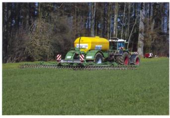
Die Cultan-Maschine von Güstrow hat eine Arbeitsbreite von 12 m und eine Leistung von etwa zwei Hektaren pro Stunde.
